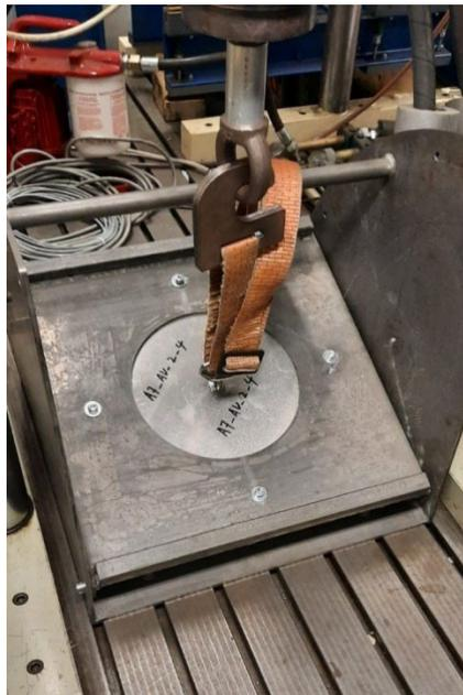
Abbildung 3: Ausreißversuch an der TH
