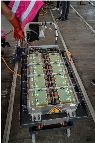
Abbildung 4: Geöffneter Akkumulator
