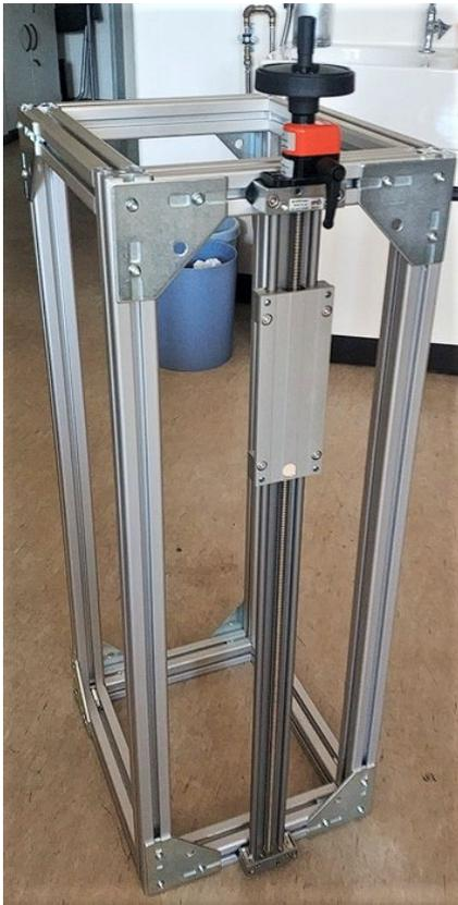
Abbildung 1: Verfahreinrichtung mit Linearführung und Führungsschlitten (einschließlich Spindel und Verfahranzeige). Bild: Fabio Gygas
