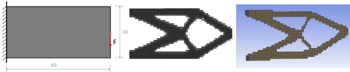
Abbildung 2: Topologieoptimierung mit SIMP-Ansatz für eine Scheibe in Matlab und mit Ansys. Bild: Julian Streicher
