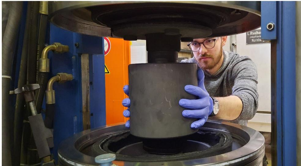
Abbildung 1: Ferdinand Nibler stellt eine Probe in die Drucksinteranlage; Foto: Hannes Kühl
