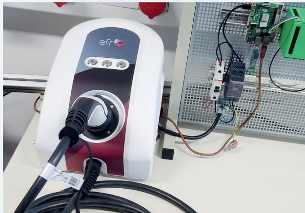
Abb. 8: Versuchsaufbau für die Entwicklung und Testen der Ladesteuerung im Labor am EnCN (Bild: Christiane Dettelbacher)
