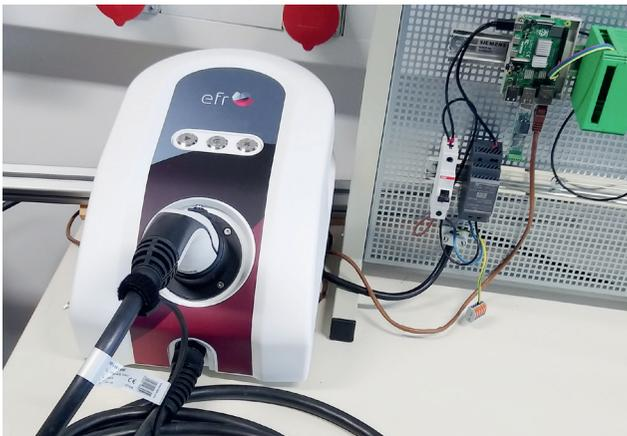
Abb. 4: Versuchsaufbau für die Entwicklung und Testen der Ladesteuerung im Labor am EnCN (Bild: Silas Leidel, Christiane Dettelbacher)
