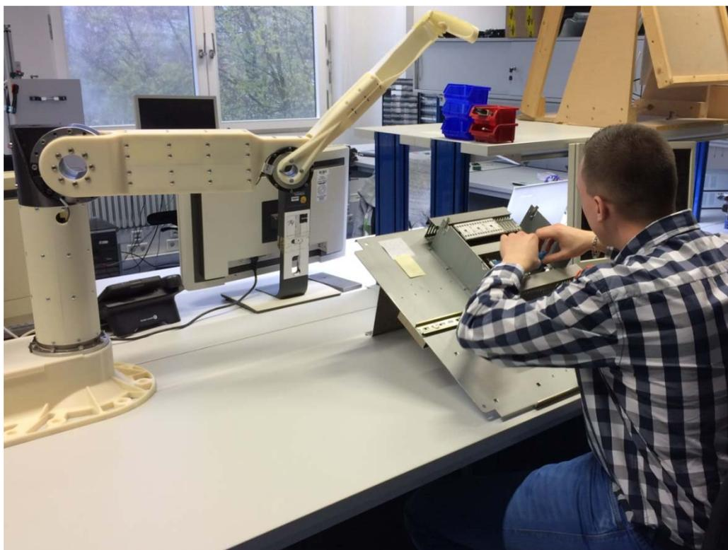
Abb. 10.: Aufbau des gefertigten BioFlexRobot-Demonstrators zur Evaluation der Eignung zur Mensch-Roboter-Interaktion.
