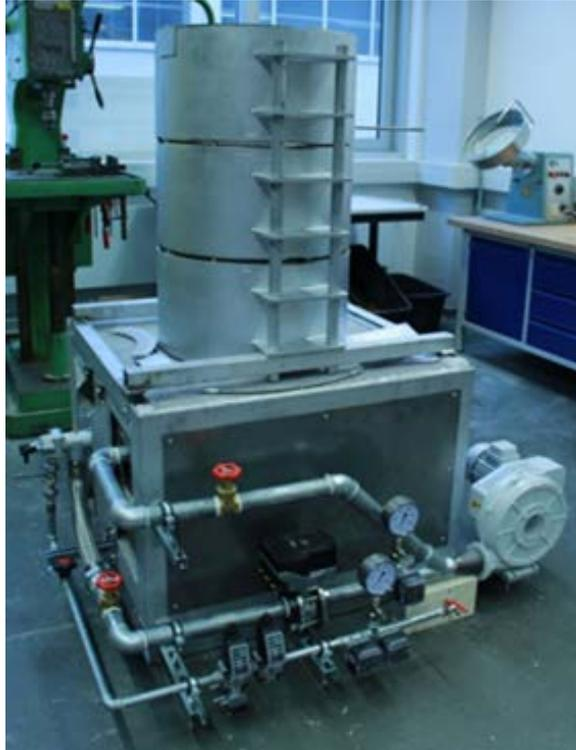
Abb. 5: Wirbelschichtreaktor mit Gasregelstrecke und Luftgebläse
