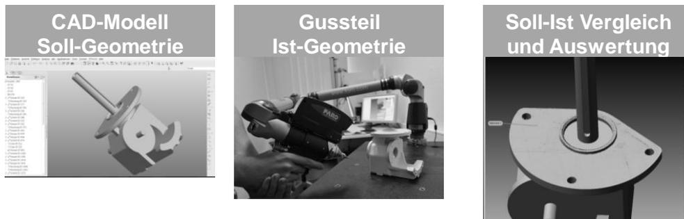
Abbildung 20: Soll-/Ist-Vergleich von Gussteilen
