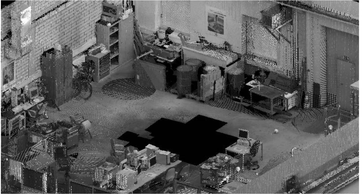
Abbildung 25: Punktwolke der Maschinenhalle, alte Maschine gelöscht [Büttner 2012]
