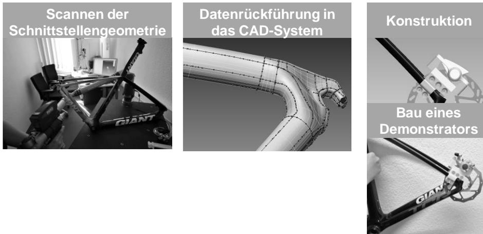
Abbildung 22: Konstruktion einer Bremsenhalterung
