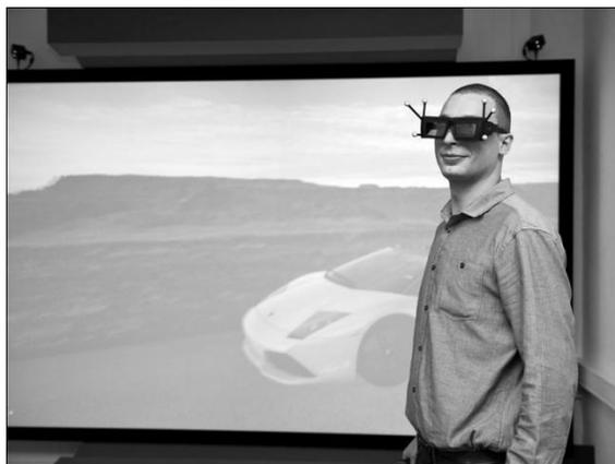
Abbildung 14: Trackingssystem mit passiven Reflektorkugeln zur Erfassung der Kopfposition
