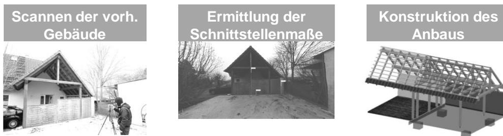
Abbildung 21: Vermessung bestehender Bausubstanz und Anbaukonstruktion
