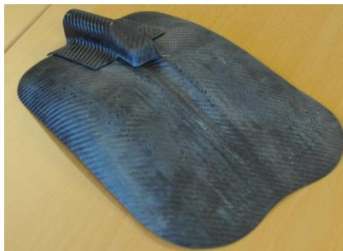
Abbildung 19: Laminieren der Schaufelstielhalterung und laminiertes CFK-Schaufelblatt
