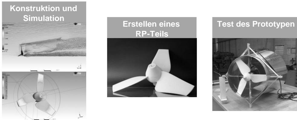
Abbildung 18: Test eines Wasserkrafrades
