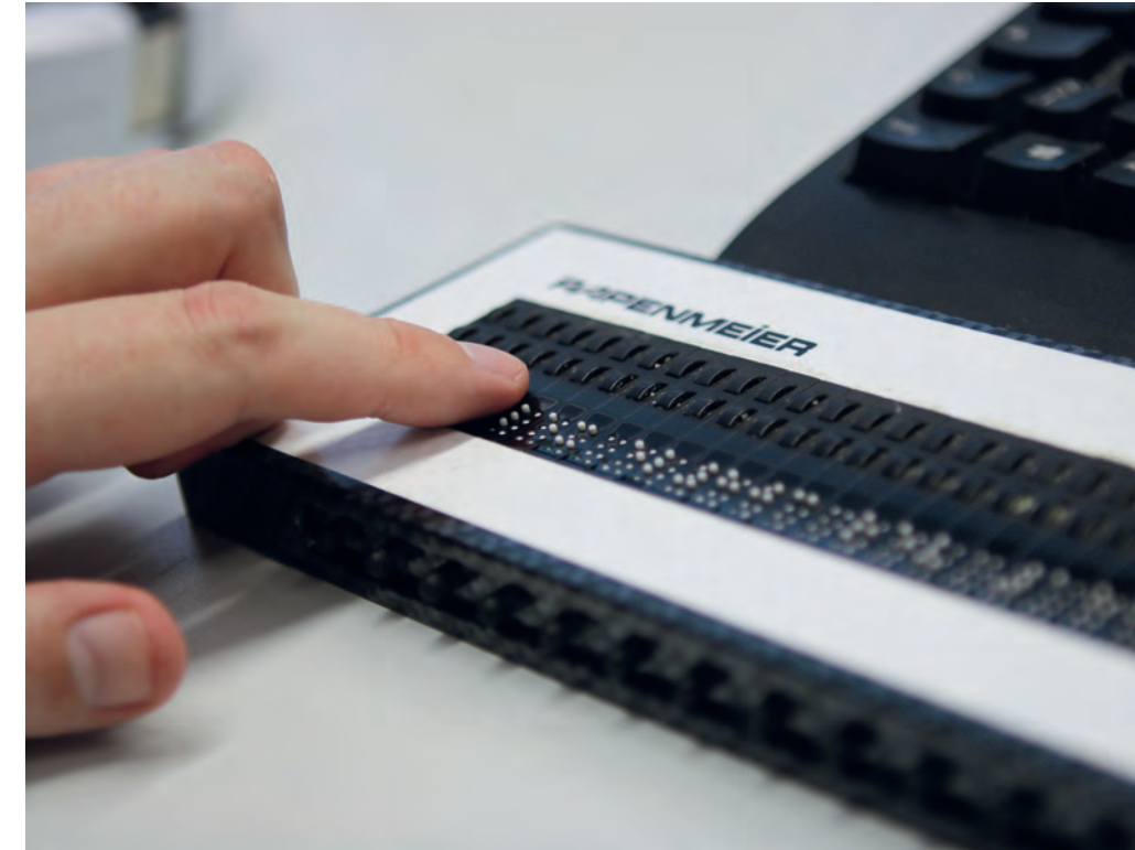
Eine Braillezeile übersetzt Informationen vom Computerbildschirm in Blindenschrift.
