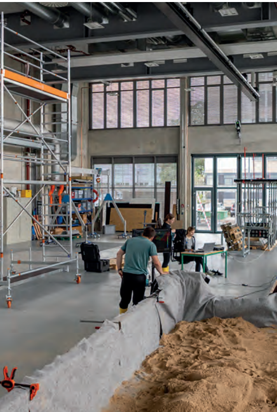
Im Wasserbaulabor werden die Modelle von Staudämmen, Talsperren oder Hochwasserschutzmaßnahmen aufgebaut und weiterentwickelt.
