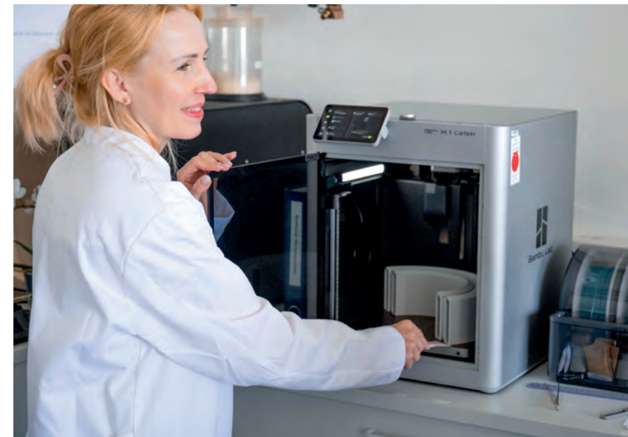
Prof. Dr. Barbara Hintz holt einen Wärmetauscher für interne Messungen aus dem 3D-Drucker.
