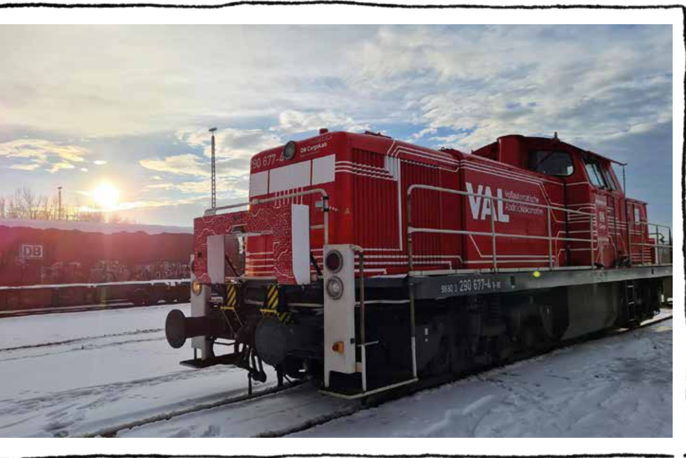
Auch das ist ein Roboter: die vollautomatische Rangierlok, entwickelt für DB Cargo. Sie ermöglicht automatisiertes Fahren auf der Schiene. Die Ohm arbeitet zusammen mit dem Karlsruher Institut für Technologie an einer neuartigen Testmethodik für die Lok-Komponenten.
