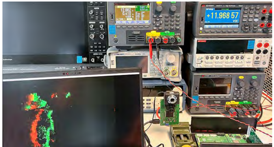
Um die Energieeffizienz des Fußgänger-Erkennungssystems zu bewerten, hat das Ohm-Team den gesamten Stromverbrauch im geschlossenen Kreislauf gemessen: Der Verbrauch stellte sich mit sieben Watt als sehr gering heraus.
