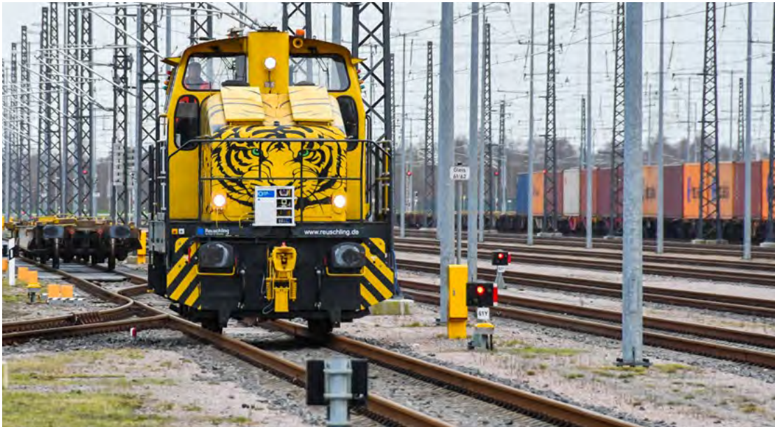
Die Lokomotive kann sich selbstständig im Gleisnetz des JadeWeserPorts bewegen, indem ihre automatisierte Steuerung unter anderem aus Rangieraufträgen, GPS- und Lidar-Sensordaten Steuerbefehle erzeugt.
