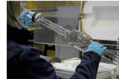
Im Innenrohr des Reaktors führt das Team die Kohlenstoff-Dotierung durch.
