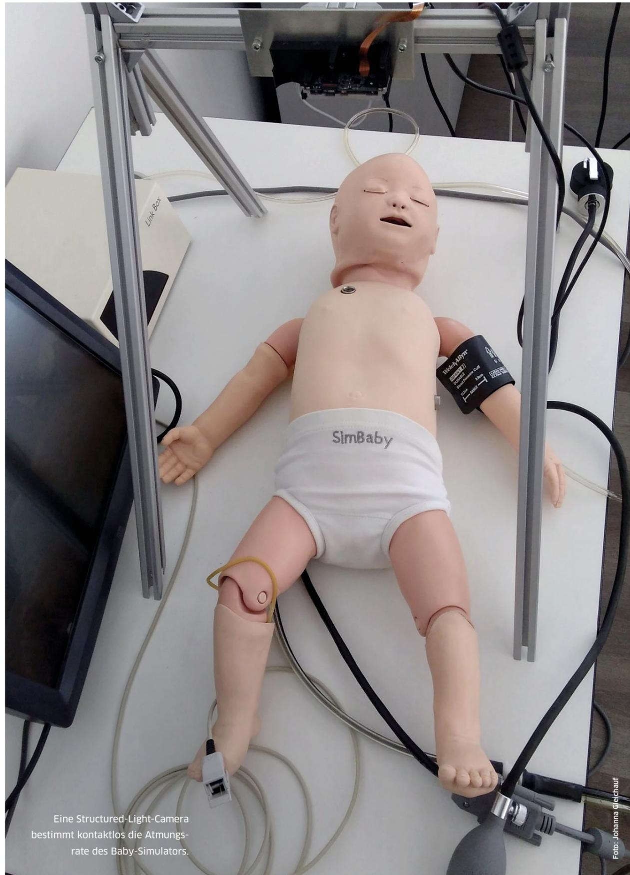
Eine Structured-Light-Camera bestimmt kontaktlos die Atmungsrate des Baby-Simulators.
