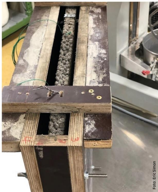
Innerhalb einer stehenden Schalung werden die PCM-Platten auf allen Seiten mit dem Mörtel umgeben.
