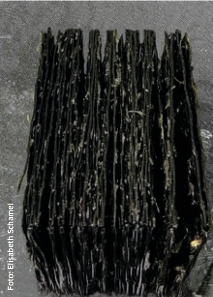
Ein aufgequollener carbonfaser- verstärkter Kunststoff (CFK).
