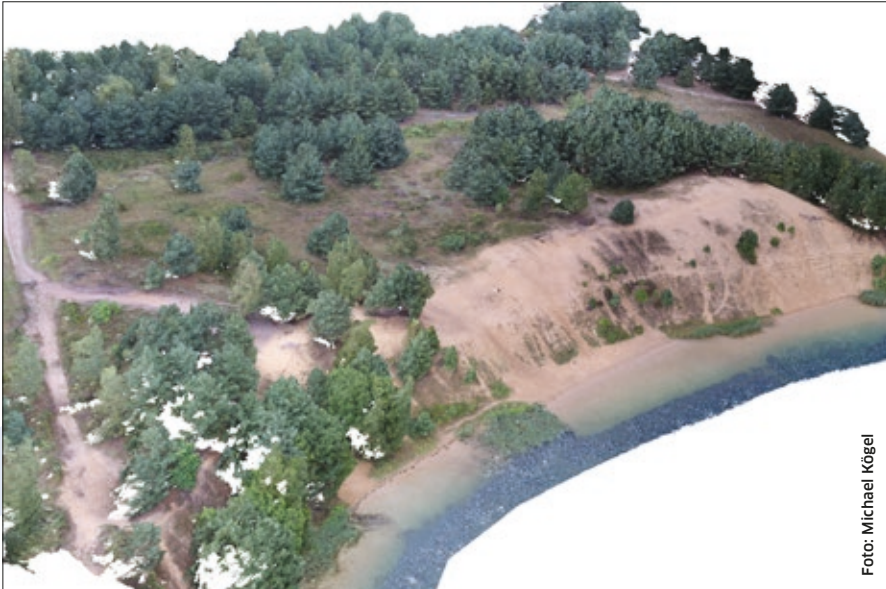
Anhand von Messdaten entsteht eine fotorealistische Abbildung einer Böschung am Scheibe-See.
