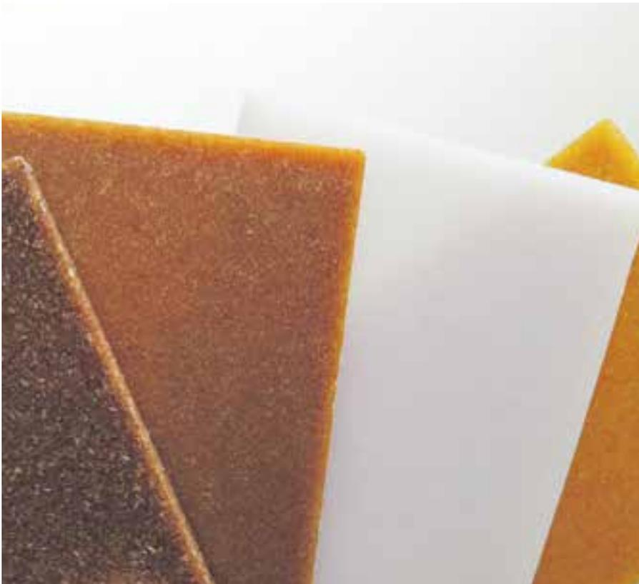
Materialmuster: ein thermoplastischer Biokunststoff mit einem sehr hohen Anteil an nachwachsenden Rohstoffen
