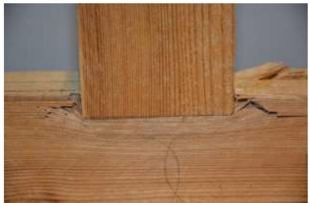
Abb. 7: Bruchbild bei einer Beanspruchung auf Querdruck
