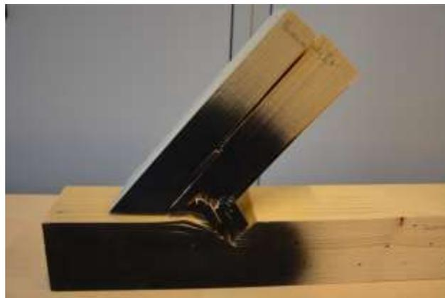
Abb. 3: Versagensform eines Fersenversatzes
