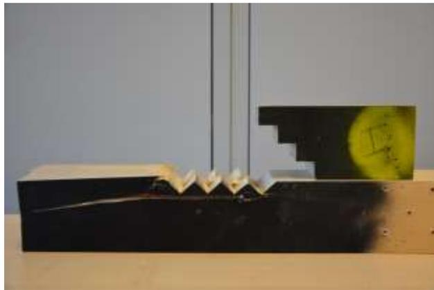
Abb. 5: Versagensform eines Treppenversatzes
