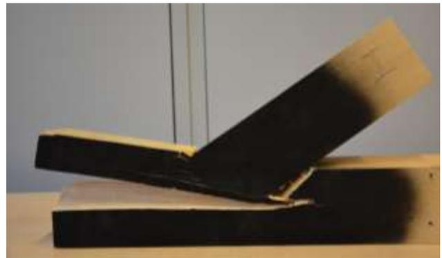
Abb. 6: Unterschiedliches Bruchverhalten beim Wellenversätzen
