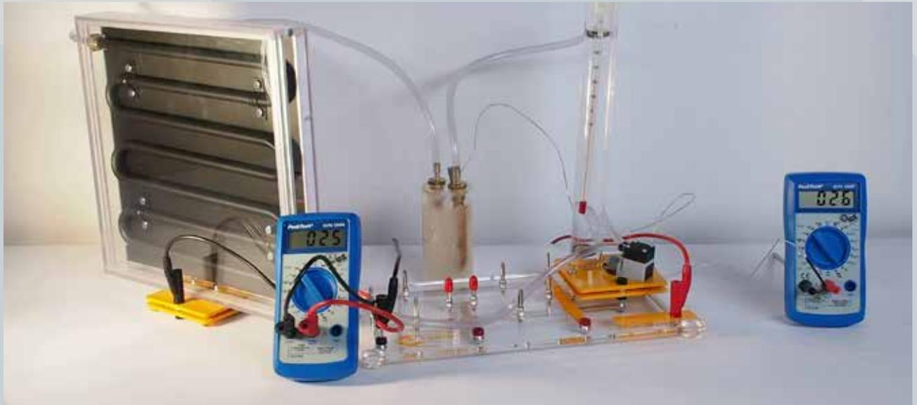
Abbildung 2: Solarthermischer Versuch mit Paraffin-Latentwärmespeicher; Foto: Peter Pfeifer
