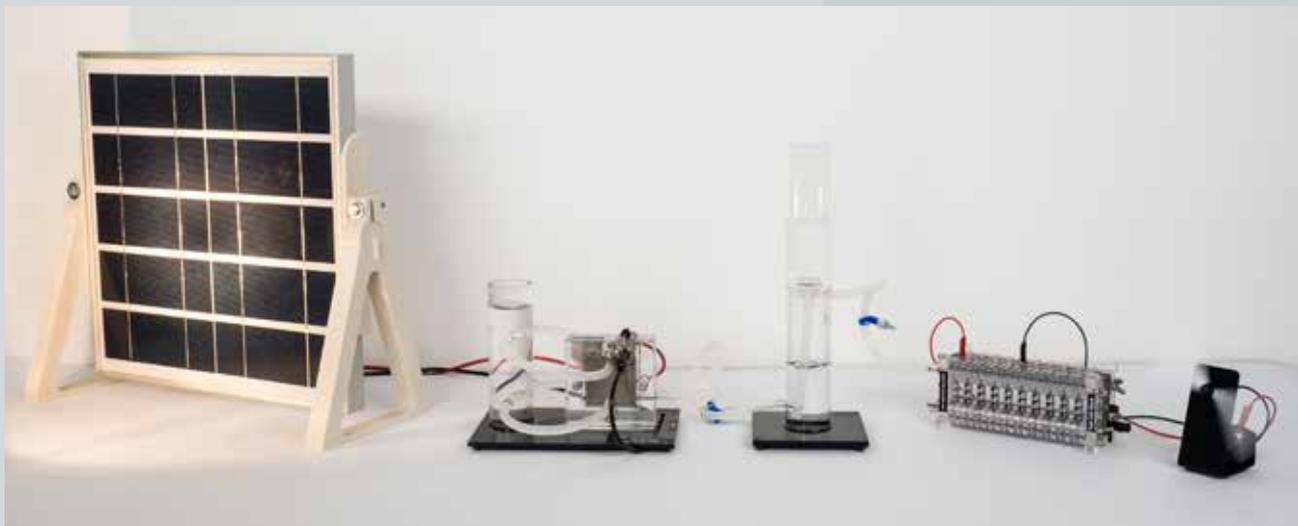
Abbildung 1: Versuch zur photovoltaischen Energieerzeugung und Energiespeicherung mittels elektrolytisch hergestelltem Wasserstoff; Foto: Peter Pfeifer
