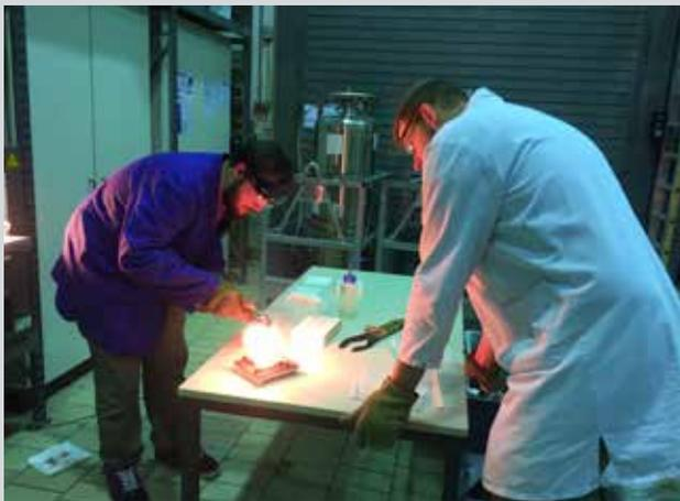
Abbildung 1: Ausgießen des geschmolzenen Glases;
