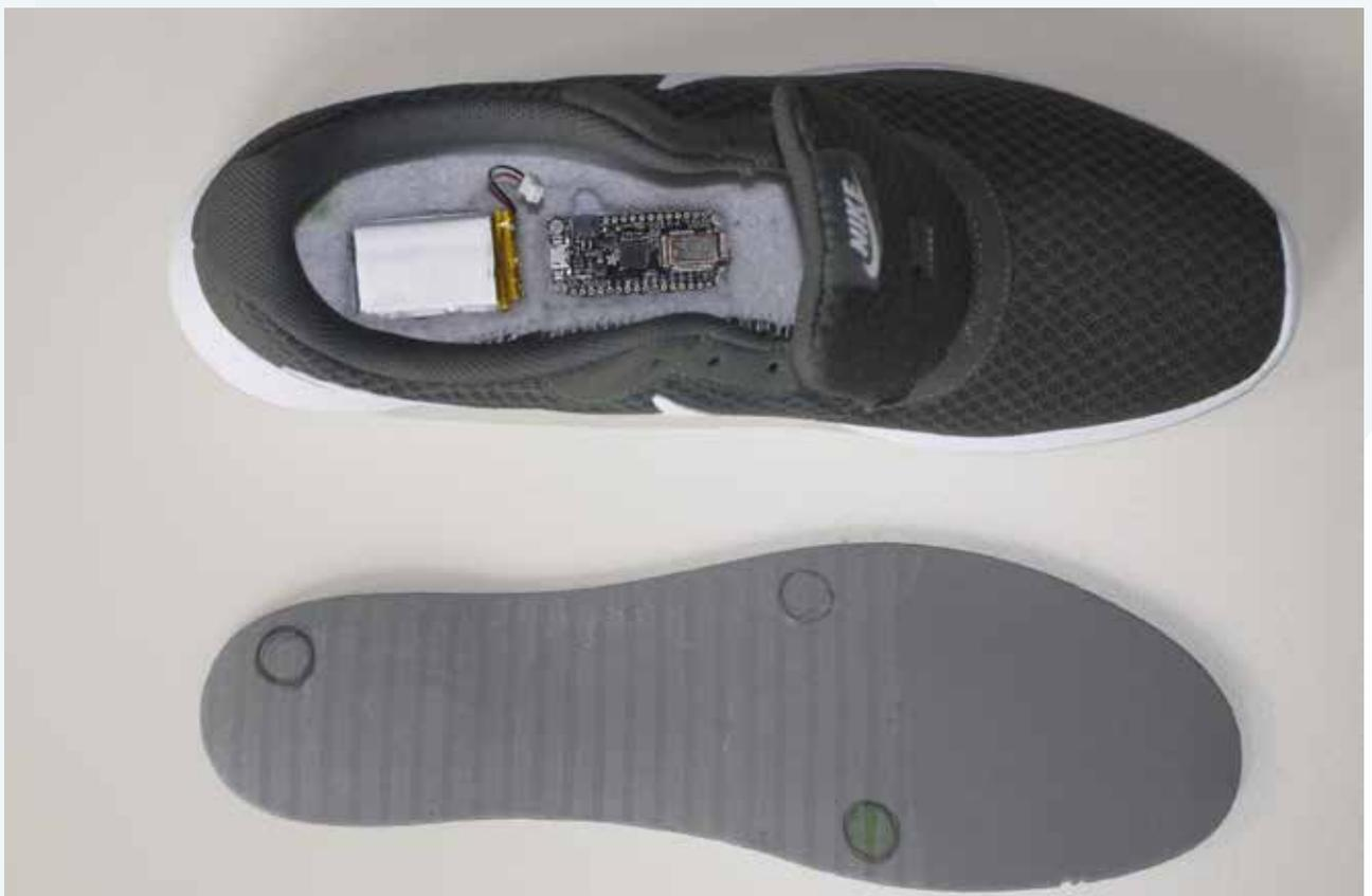
Abbildung 5: Modifizierter Schuh zur Unterbringung von Energieversorgung und Mikrocontroller und angedeutete Sensorpositionen; Foto: Hertel et al.
