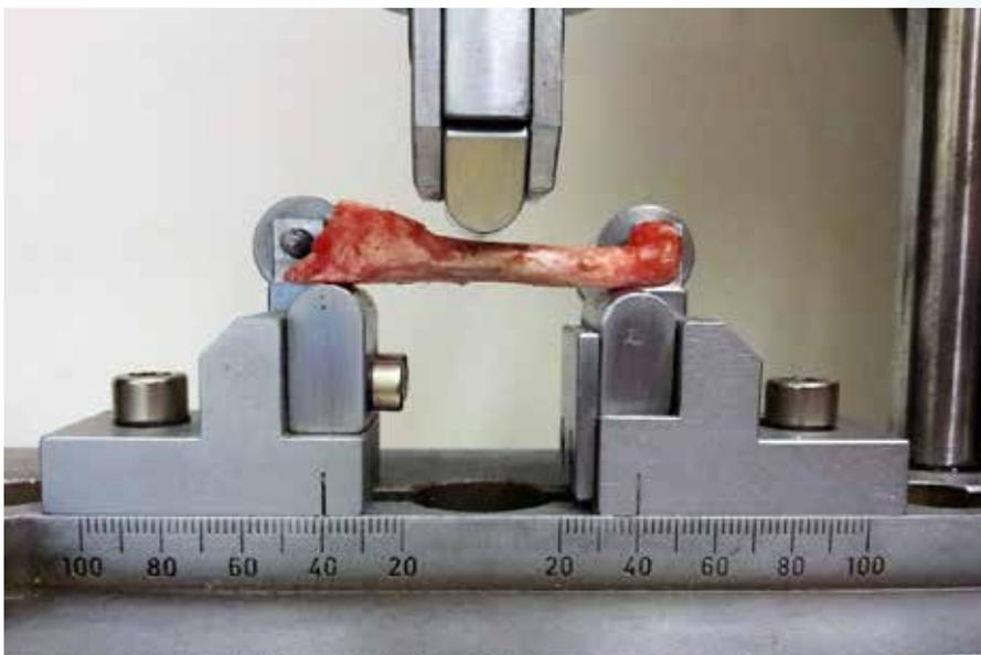
Abbildung 9: Aufbau des Biegeversuchs; Foto: Rüdiger Hornfeck
