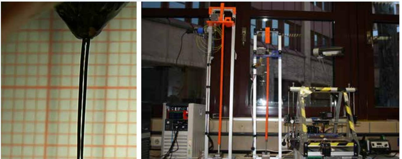
Abbildung 3: Versuchsaufbau. Links: extrudierter Strang aus Düse mit USB-Mikroskop beobachtet
