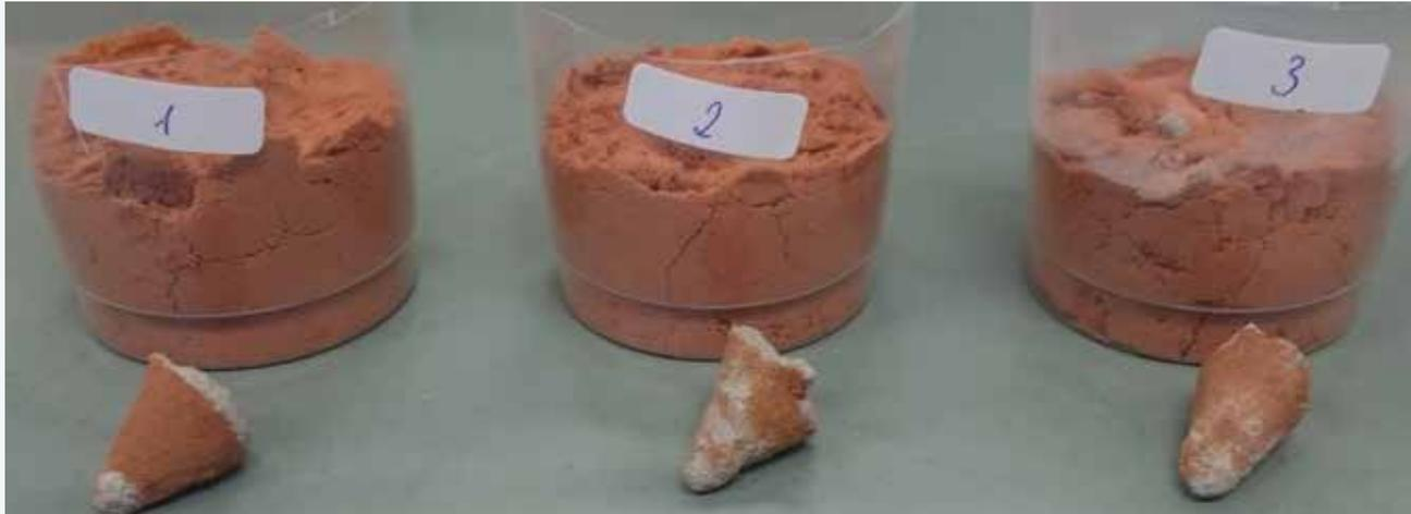
Abbildung 2: graue Polymermörtelkegel mit anhaftendem roten Formsand; Foto: Michael Mirke
