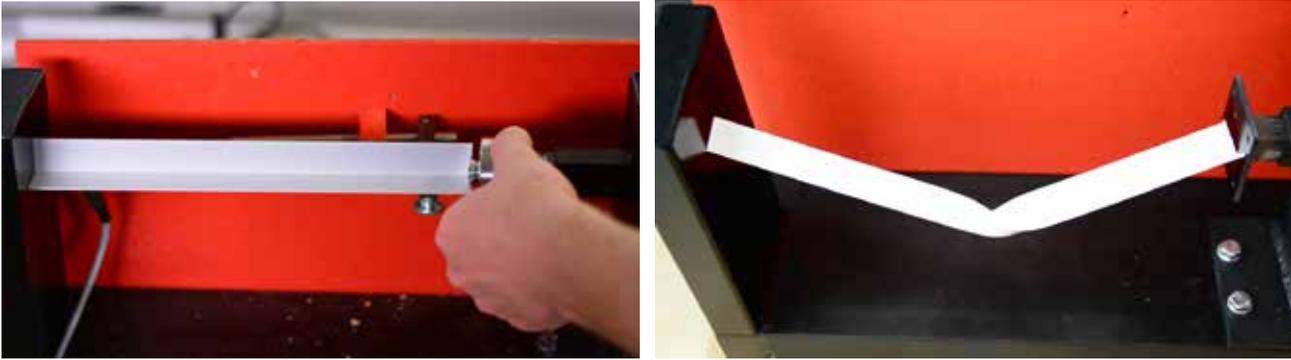
Abbildung 4: Aluminium-Probekörper eingespannt in der hydraulischen Presse. Fotos: Fabian Strobl
