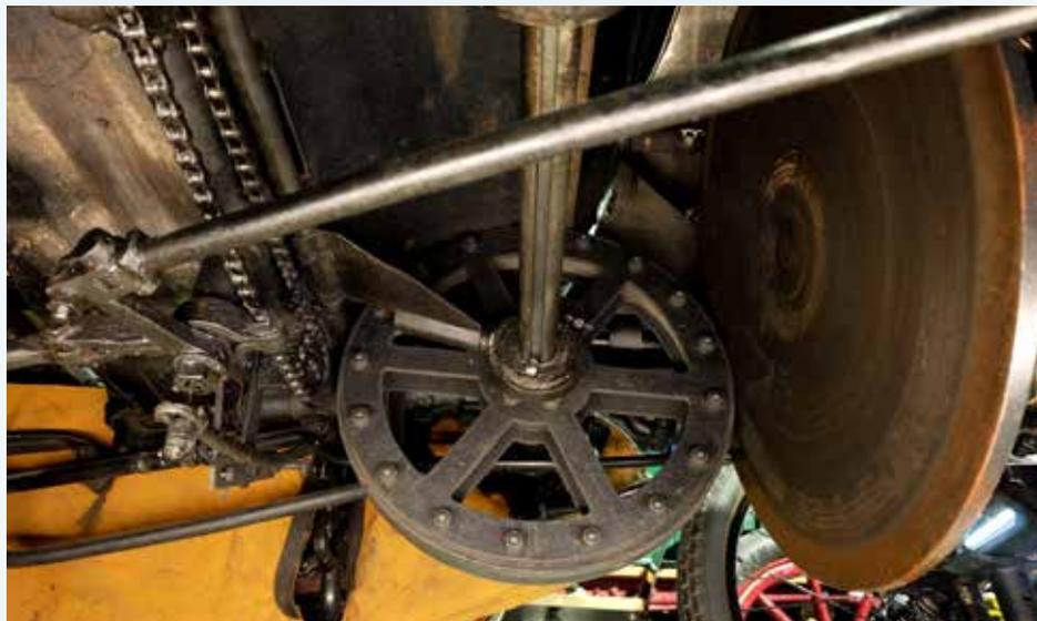
Abbildung 2: Blick in einen im Museum Industriekultur ausgestellten Reibradmotor, den die Nürnberger Firma Maurer hergestellt hat und der eine stufenlose Einstellung der Übersetzung erlaubt. Foto: A. Straubinger
