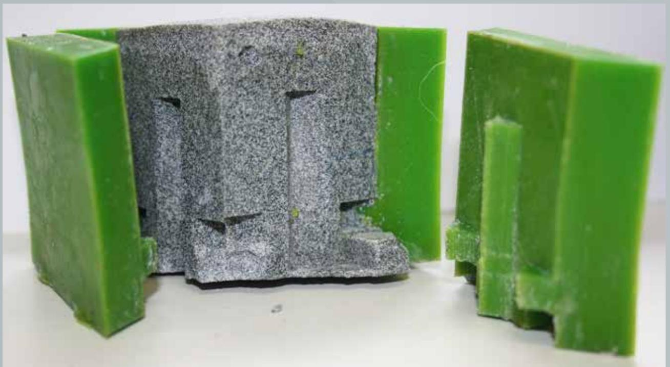
Abbildung 4: Polymerbetonpositiv, in 3D-gedruckter Negativform gewonnen; Foto: Michael Mirke
