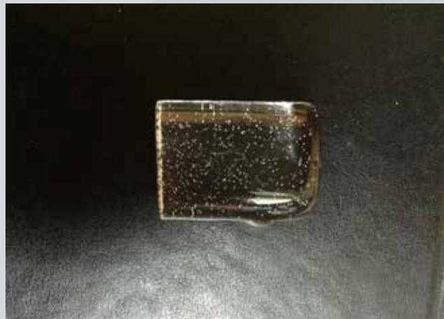
Abbildung 2: Modellglasbarren mit deutlich erkennbaren Gaseinschlüssen;
