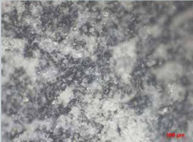
Abbildung 3: Lichtmikroskopie-Aufnahme der aufgetragenen und ausgelegerten Gipsschicht; Foto: Luca Fürst
