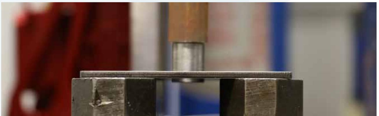
Abbildung 5: Scherversuche NoRa 5; Foto: StrOHM + Söhne
