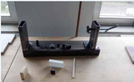
Abbildung 3: Einbau der Prüfkörper und Belastung bis zum Stabilitätsversagen. Foto: Fabian Strobl
