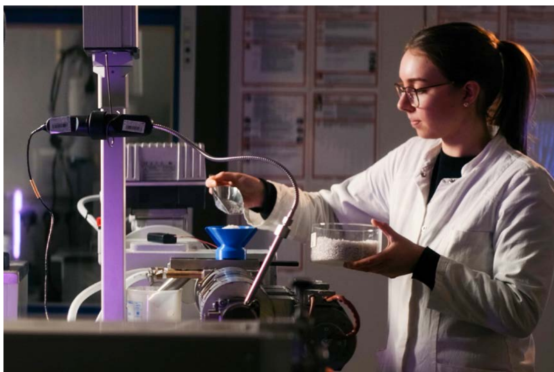
Die Plastikflaschen häckselte Nora Zieler zu einem Granulat, das sie weiterverarbeiten konnte.
