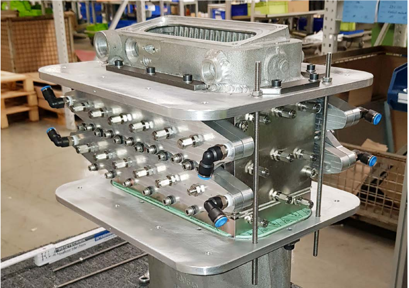
Die Brenneinheit mit TE-Generator und Wärmeübertrager hat eine außenliegende Kühleinheit für thermoelektrische Generatoren und befindet sich hier noch im unaufgebauten Zustand.
