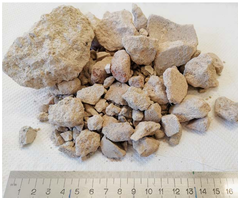
Bauschutt zählt zu den größten Abfallströmen in ganz Deutschland. Derzeit werden nur etwa 61 Prozent davon recycelt und für neue Projekte eingesetzt.
