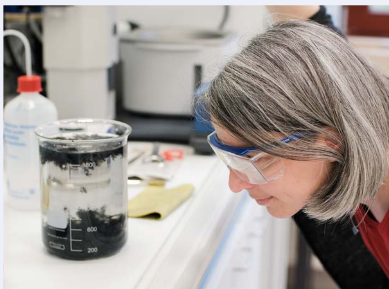
Mit den frisch hergestellten Kohlenstoff-Titanat-Nanotubes (C-TNT) möchte Prof. Dr. Uta Helbig die Lebensdauer von Elektroden erhöhen.
