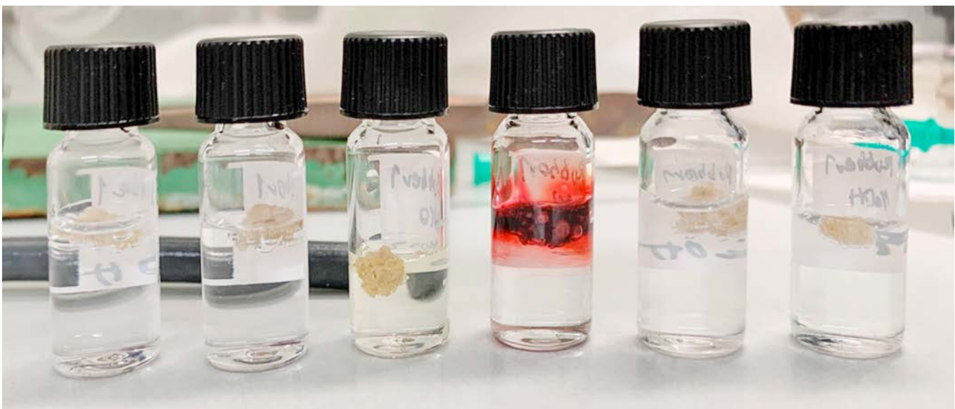
Das zerkleinerte Gummigranulat wurde in verschiedene Lösungsmittel und Säuren eingelegt, um den Lösungsprozess des Silicons zu erforschen.
