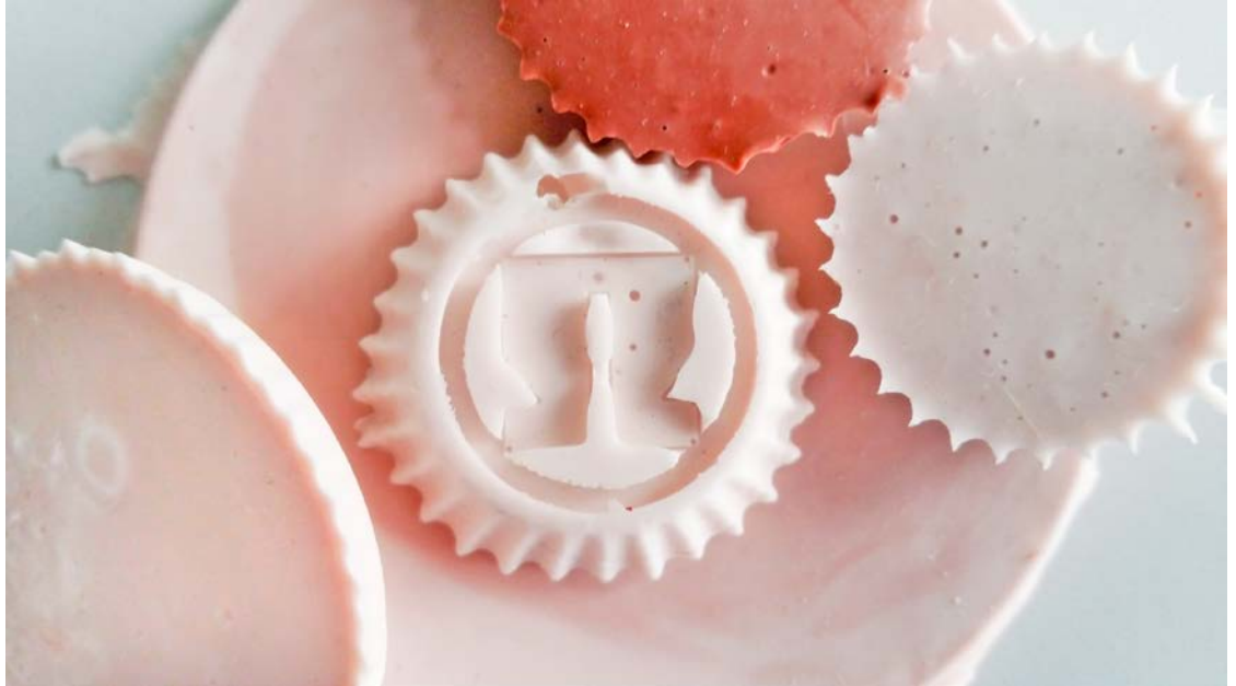
Mit kommerzieller Silicon-Abformmasse lässt sich zum Beispiel das OHM-Logo abformen. Sie ist das aktuelle Ausgangsmaterial für die laufenden Forschungsarbeiten.
