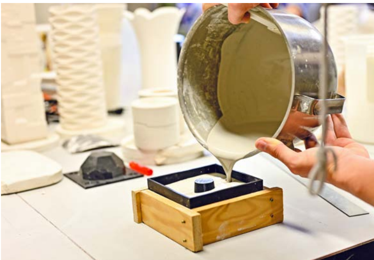
Das Projektteam stellte Objekte aus dem 3D-Drucker und formte daraus die Gipsform.
