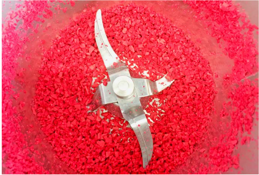
Für die Versuche zerkleinerte das Team die gummiartige Silicon-Abformmasse zu Gummigranulat.
