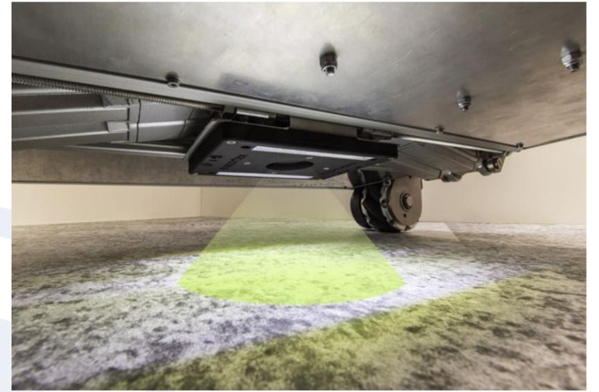
Durch eine Kamera analysiert die Roboterplattform die Bodenstrukturen.
