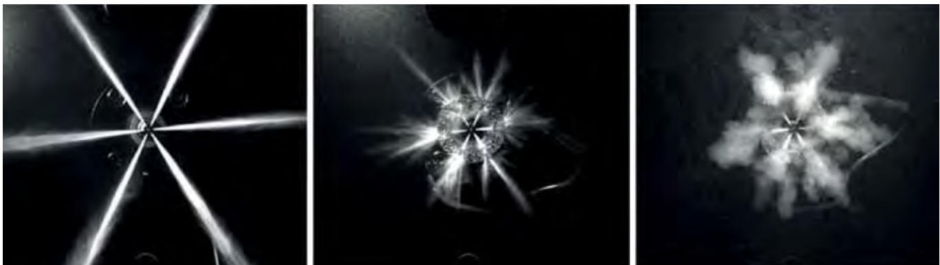
Bessere Kraftstoff-Verteilung im Raum: Links eine herkömmliche Dieseleinspritzung bei 20°C, in der Mitte einer Einspritzung mit Zerstäubungselement bei derselben Temperatur. Rechts: Einspritzung und Verdampfung bei 250°C.
