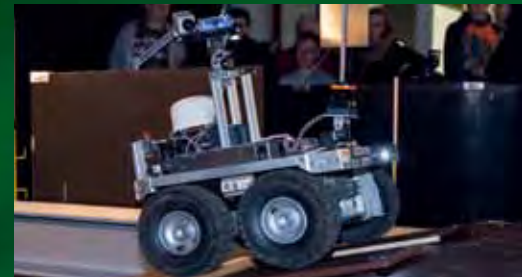
Lebensretter in Aktion: Der Roboter Georg sucht in Katastrophengebieten nach Opfern und Gefahrenstoffen und schätzt die Gefährlichkeit der Lage für Rettungskräfte ein. Welche Technik dahinter steckt, zeigt die Fakultät Elektrotechnik Feinwerktechnik Informationstechnik.
