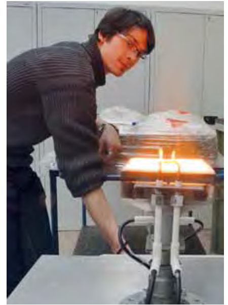
Peter Weigand bei der Vorführung einer flammenlosen Verbrennung im porösen Reaktor.
