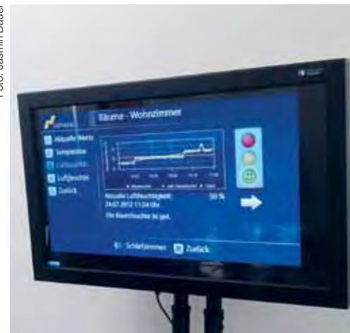
Alles im grünen Bereich: Auf dem Bildschirm der Raumklimastation ist zu sehen, dass Luftfeuchtigkeit und Raumtemperatur normal sind.
