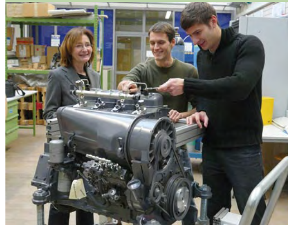
Arthur Brandt und Alexander Rohleder erklären Dr. Heidi Willer von der N-ERGIE, wie sie gerade einen Injektor an das Common-Rail des Versuchsmotors anschließen (von rechts).
