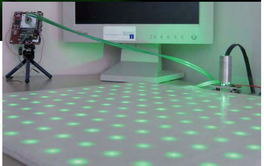
Technik, die nicht nur hilft, sondern auch schön aussieht: Die Sensormatte mit polymeroptischen Fasern.
