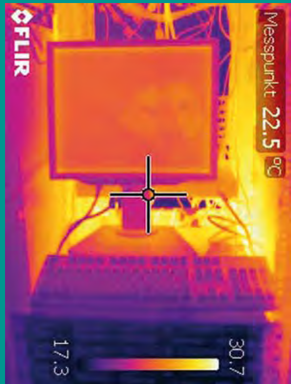
... und hier eine Wärmebildkameraaufnahme des Monitors, auf der die Temperaturunterschiede klar zu erkennen sind.
