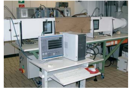
Versuchsstand im Labor für Wärme- und Stoffübertragung. Hier wurden die Drahtgestricke getestet.
