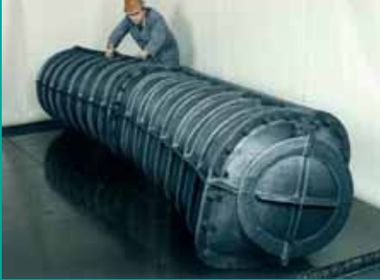
In Wirklichkeit fünf Meter lang: eine Blasform aus kohlenstofffaserverstärktem Kohlenstoff (CFC)
