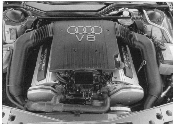
Abb.3. V8-4.2 Liter Benzinmotor des Testfahrzeugs (Audi S4)
