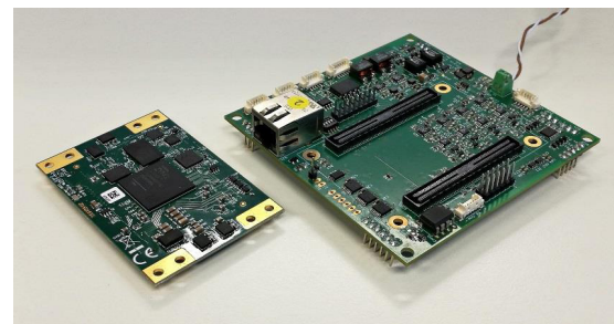
Abb. 1 : Eigenentwicklung eines SoC-Systems für die Regelung von elektrischen Antrieben im Rahmen der Vorlaufforschung
