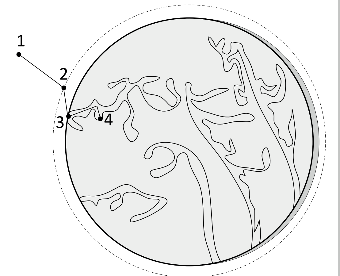
Abb. 2: Granuliertes Silikagel -Kugelgröße 2-3mm- (links) und Teilschritte der Adsorption (rechts)
