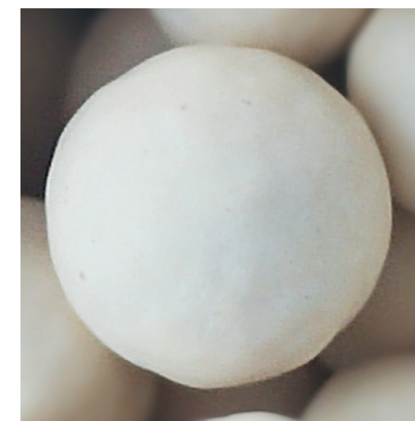
Abb. 2: Granuliertes Silikagel -Kugelgröße 2-3mm- (links) und Teilschritte der Adsorption (rechts)
