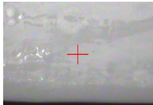
Abbildung 13: Mit Dimethylketon behandelter ABS-Prüfkörper
