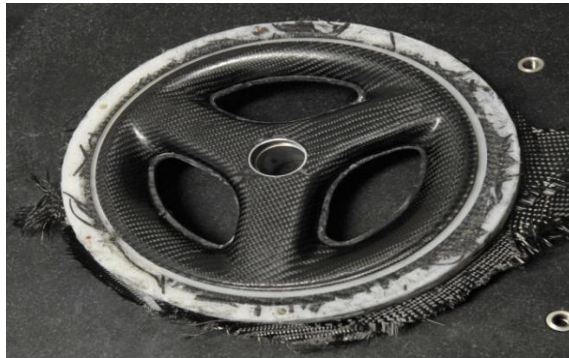
Laminierte CFK-Felge mit noch nicht gelöstem Kernmaterial
