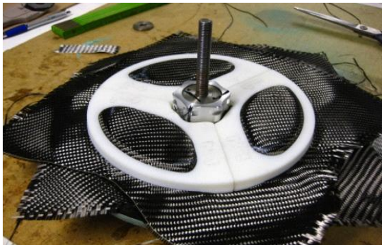
wasserlösliches Kernmaterial, eingelegt in das Kohlefasergewebe
