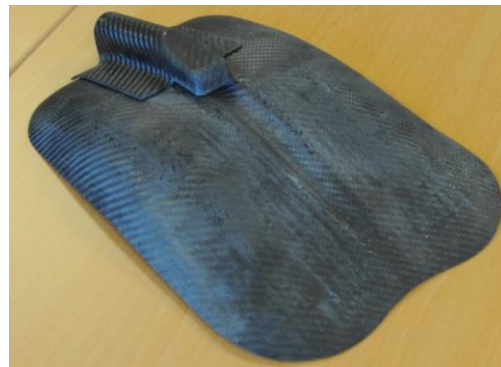
Abbildung 19: Laminieren der Schaufelstielhalterung und laminiertes CFK-Schaufelblatt
