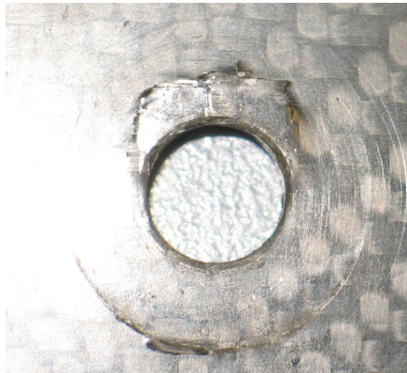
Abbildung 33: Laminatschädigung im Kontaktbereich Unterlegscheibe/Probenoberfläche
