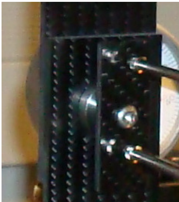
Abbildung 30: Messaufbau zur Messung der Bolzenschrägstellung
