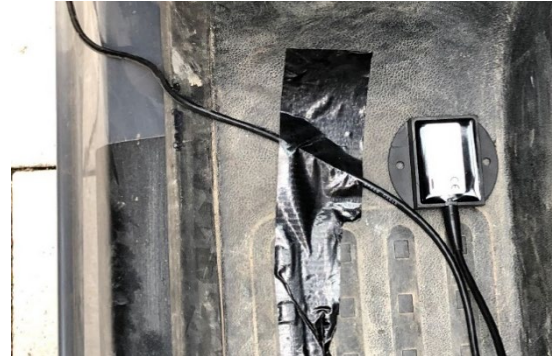
Abbildung 55: Externer Sensor im Einstieg
