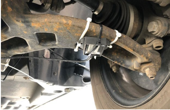
Abbildung 54: Externer Sensor am Radträger
