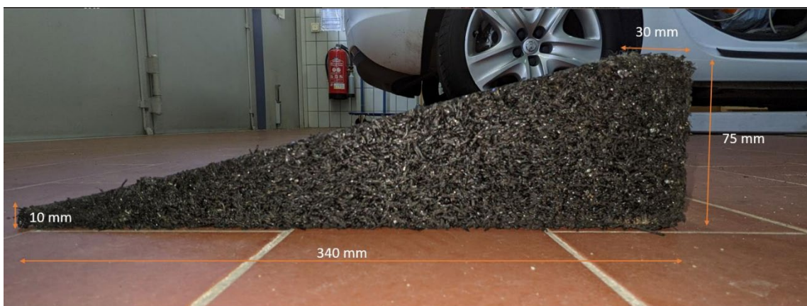
Abbildung 46: Definiertes Hindernis "Rampe"
