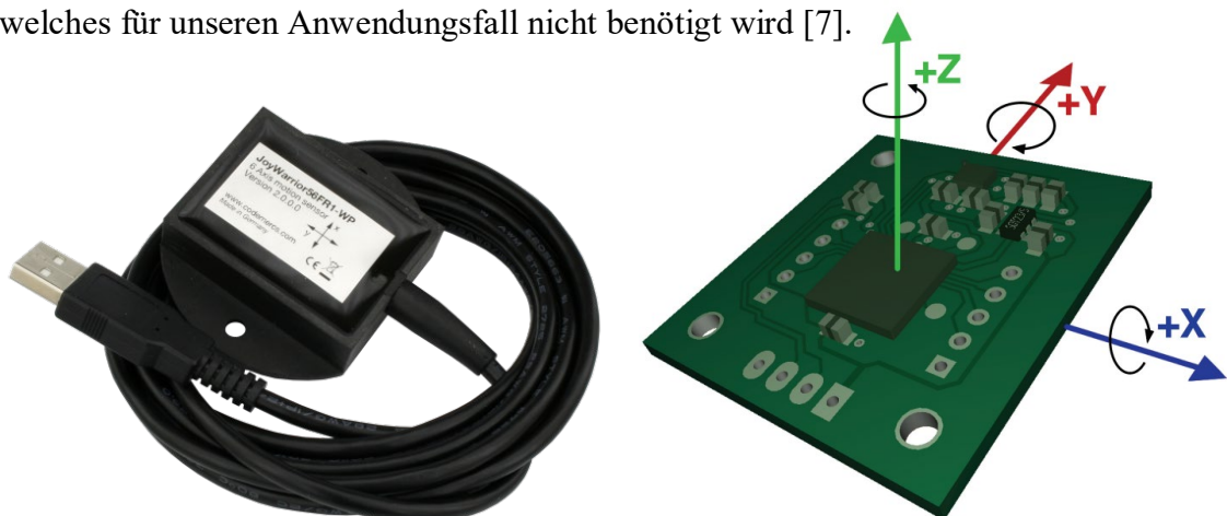
Abbildung 3: JW56FR1 und Anordnung der Achsen des Sensors [8, 9]
