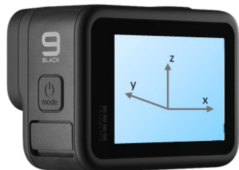
Abbildung 13: Anordnung der Achsen bei der GoPro [12] abgeändert
