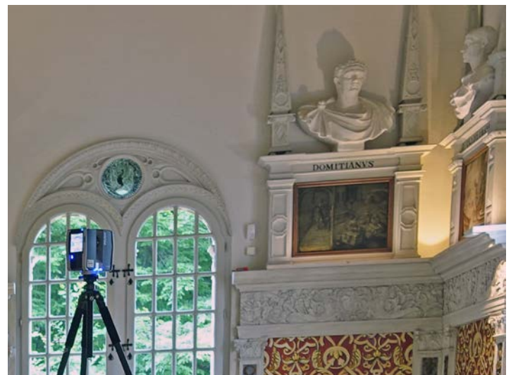
Scannen des Hirsvogelsaals mit dem 3D Laserscanner
