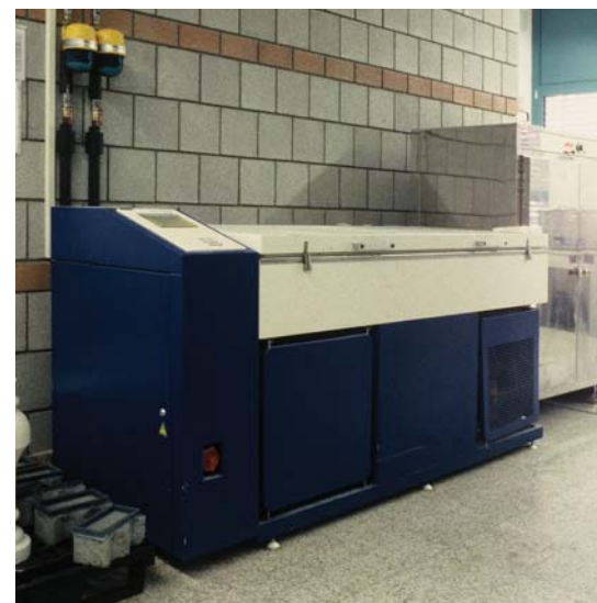
Abb. 7.77 Truhe zur Steuerung der Frost-Tau-Zyklen
