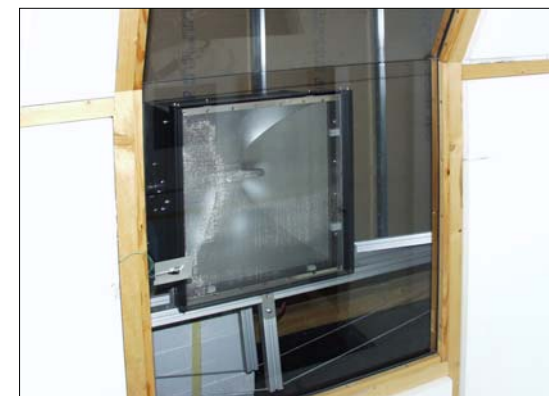
Abb. 7.62 In den Sonnensimulator eingebaute Holzleichtbetonprobe. Davor in Bildmitte ist ein Solarimeter zu erkennen, das die auf die Probe einfallende Strahlungsinintensität mißt
