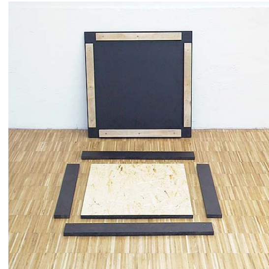
Abb. 7.10 Schalung mit Grundplatte, Wechselboden und seitlichen Abschalern
