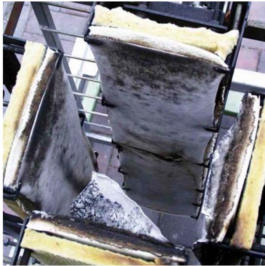
Abb. 7.96 Brandschacht (auf dem Photo keine Holzleichtbeton-Proben) vor dem Prüfverfahren
