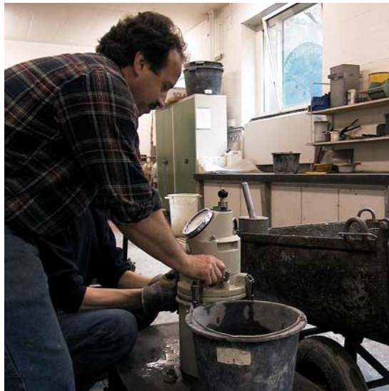
Abb. 7.40 Ermittlung des Luftporengehalts des Frischbetons mit dem 'Luftporentopf'
