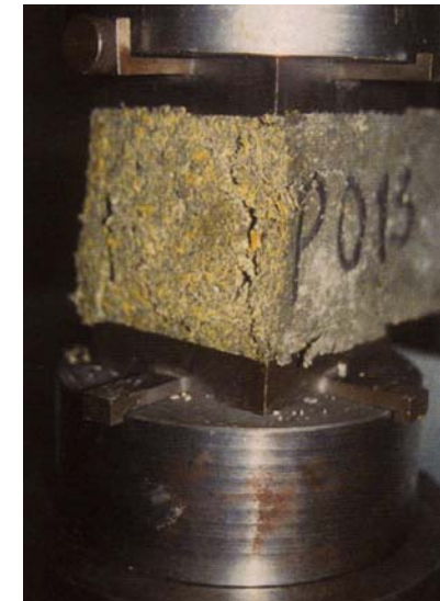
Abb. 5.5 Druckfestigkeitsversuch an einem Holzleichtbeton-Prüfkörper (EPF Lausanne/I-Bois)
