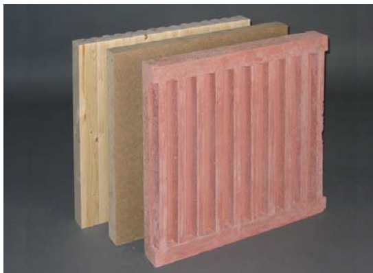
Abb. 2.2 Herstellung von Musterplatten aus Holzleichtbeton
