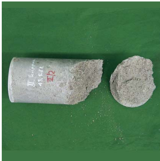
Abb. 7.43 Prüfzylinder (R II/2) mit offener Bruchstelle nach Druckfestigkeitsversuch
