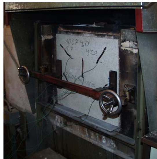
Abb. 7.91 Musterplatte im Kleinbrandofen
