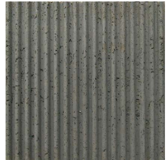
Abb. 10.4.1c Oberfläche der Mischung 1 'Welle'/Reckli #2/94 (Verkleinerung, Platte 60 x 60 cm)
