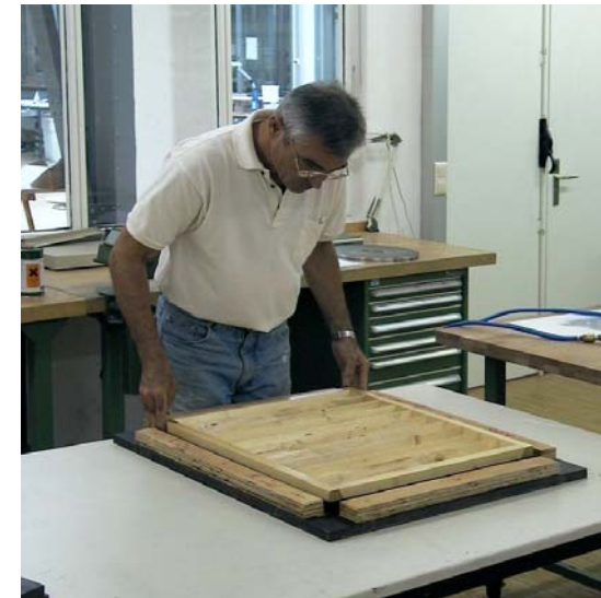
Abb. 8.14 Zusammenbau der so genannten Strukturschalung "Absorber" (aus Holz)
