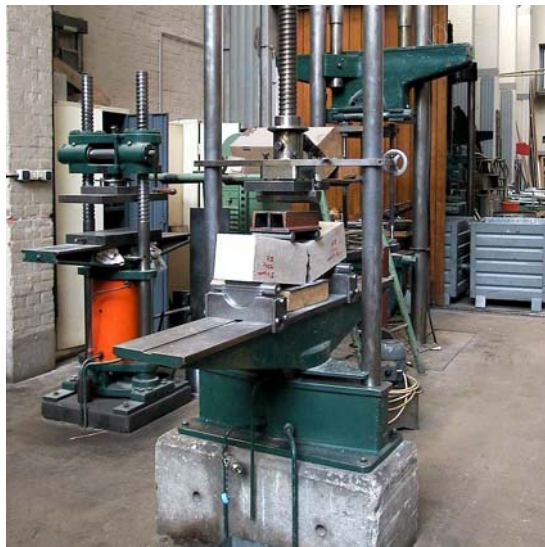
Abb. 7.48 Biegezugfestigkeits-Messung an einem Prüfprisma 100 x 100 x 700 mm
