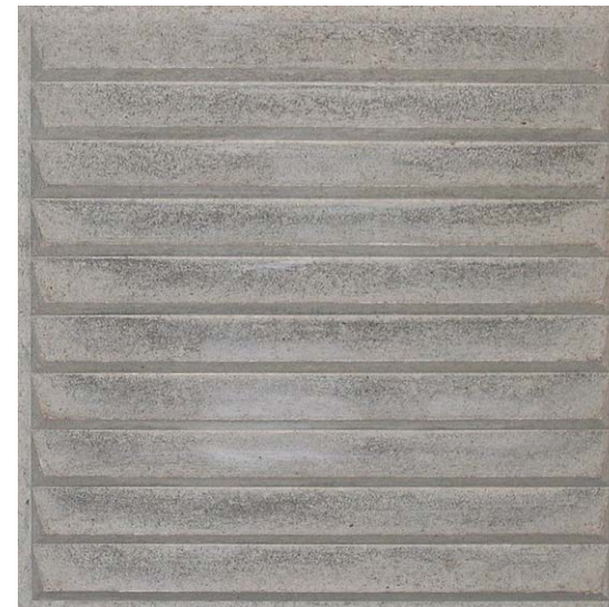
Abb. 10.4.2c Oberfläche der Mischung 2 Absorber (Verkleinerung, Platte 60 x 60 cm)
