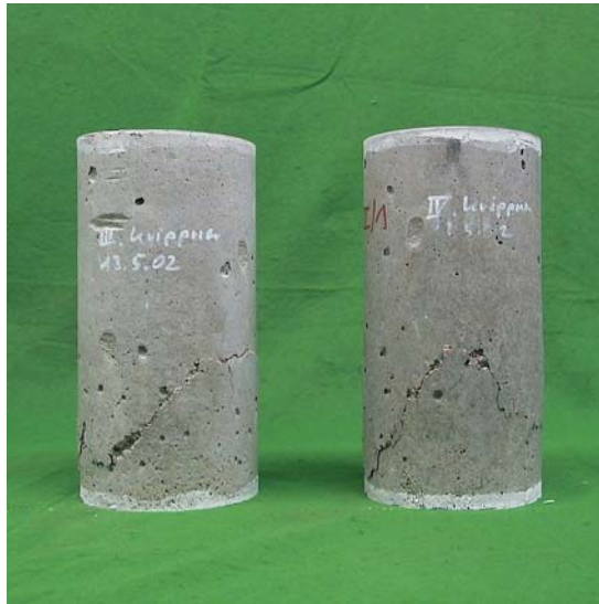
Abb. 7.42 Prüfzylinder (R III, links/ R VI/IV)1, rechts) mit unterschiedlichem Bruchbild nach Druckfestigkeitsversuch
