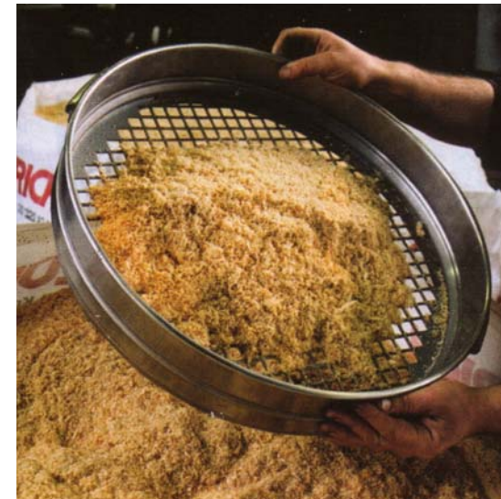
Abb. 5.2 Manuelles Sieben des Restholzsoriments (EPF Lausanne/I-Bois)
