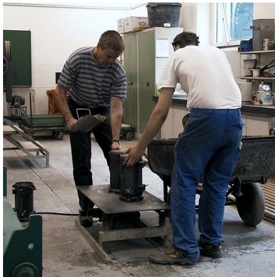
Abb. 7.41 Verdichtung von Prüfzylindern auf einem Flachrüttler
