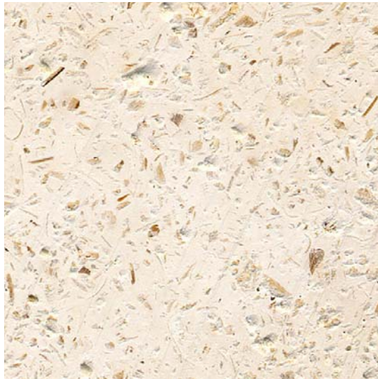
Abb. 8.24 Holzleichtbeton-Oberflächen mit Weißzement (EPFL/I-Bois, 2000)
