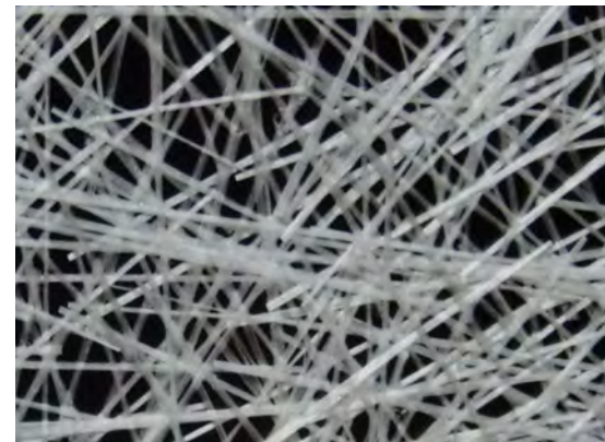
Abb. 39: Lose, hoch integrale Glasfasern, Länge 12 mm links M 2:1 / rechts M 5:1
