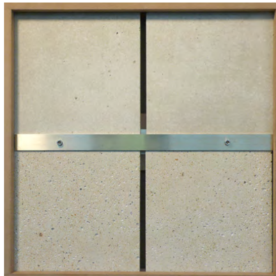
Abb. 86: (rechts unten) Detail Befestigungsvariante Typ C mit Flachstange aus gebürstetem Edelstahl als Deckprofil, Stoßfugen versetzt, obere Platte mit dunklen Pigmenten eingefärbt, untere Platte mit Weißzement
