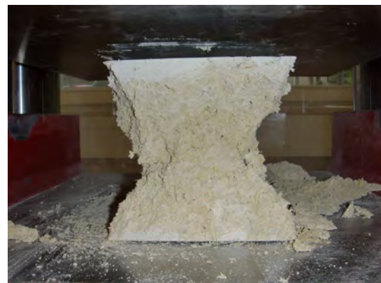
Abb. 22: Prismenprüfkörper (Hälfte, unbewehrt) nach Druckfestigkeitsprüfung
