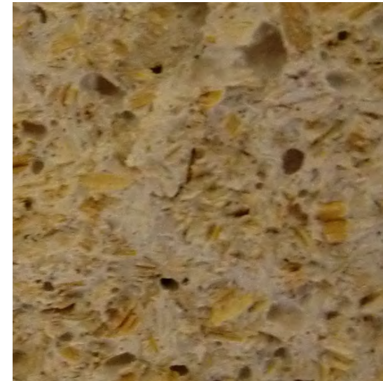
Abb. 12: Bruchfläche von Holzleichtbeton (unbewehrt) bei Ausbreitversuch
