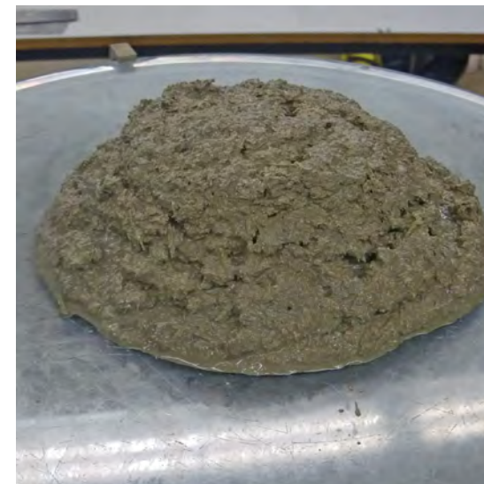
Abb. 13: Konsistenz von Holzleichtbeton (unbewehrt) bei Ausbreitversuch
