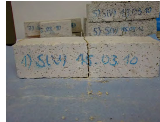
Abb. 16: Prismenprüfkörper (unbewehrt) nach Biegezugfestigkeitsprüfung
