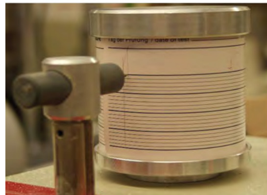
Abb. 6: Messprotokoll (Vicat-Gerät) zur Ermittlung der Erstarrungszeiten [min] (hier für Z 1)
