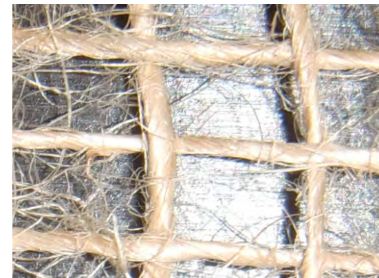
Abb. 34: Jutegewebe, Maschenweite 4,5 \text{ mm} ; M 5:1
