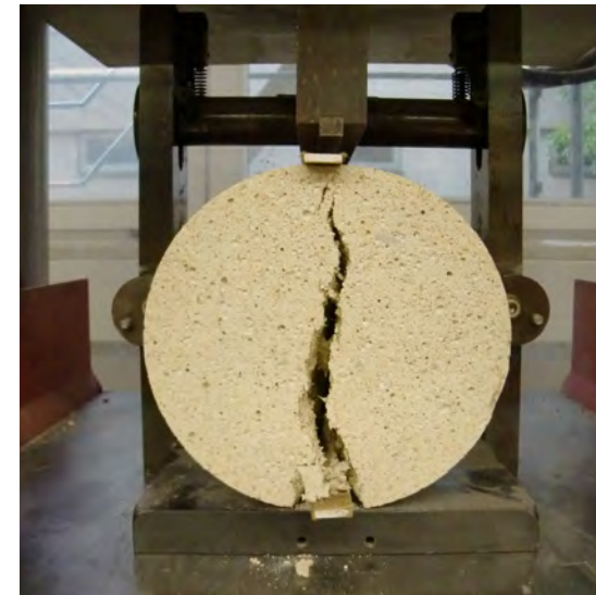
Abb. 20: Holzleichtbeton-Zylinder (unbewehrt) nach Spaltzugfestigkeitsprüfung
