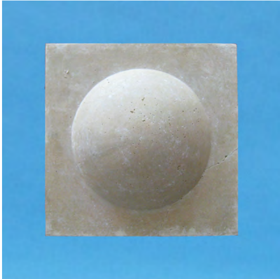
Abb. 118: Deckenplatte mit ausgeprägter Wölbung im Plattenfeld
