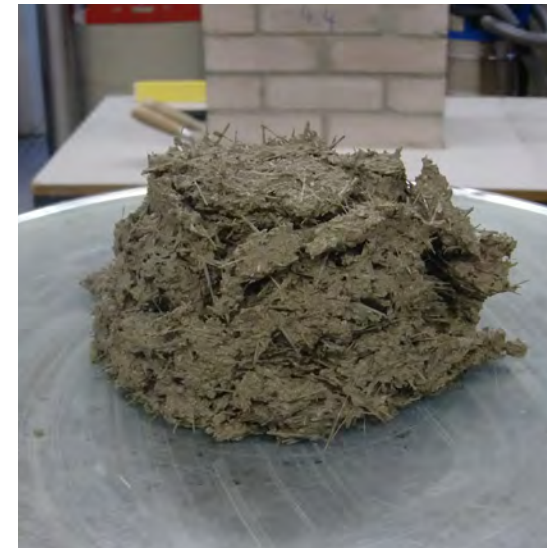
Abb. 43: Konsistenz von Holzleichtbeton (bewehrt mit K3 (GF)) bei Ausbreitversuch
