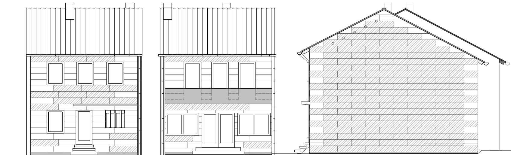
Abb. 51 Nürnberg-Neunhof, Reihen-Endhaus (1969) / Konzept Fassadensanierung "Querformatige Platten" (2012/2013) Schraffierte Flächen 'Standard'-Platten; weiße Flächen Anpassungen bzw. Sonderformate
