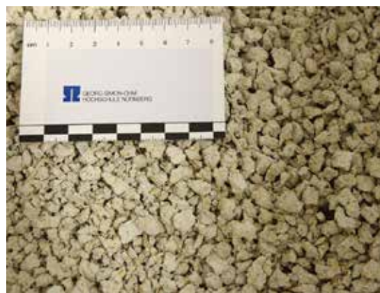
Abb. 20 Rezyklierung von Holzleichtbeton (rHLB)
