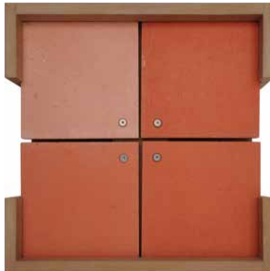
Abb. 30 MK_2, Edelstahl Rundkopfschraube 5*50 mm mit handelsüblicher Beilagscheibe
