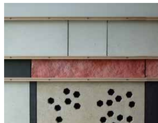
Abb. 23 HLB-Fassadenplatten. Studentisches Projekt, Ergänzungsfach "Baustoffkunde" / Seminar, TU München, WS 2006/07 (mitte)
