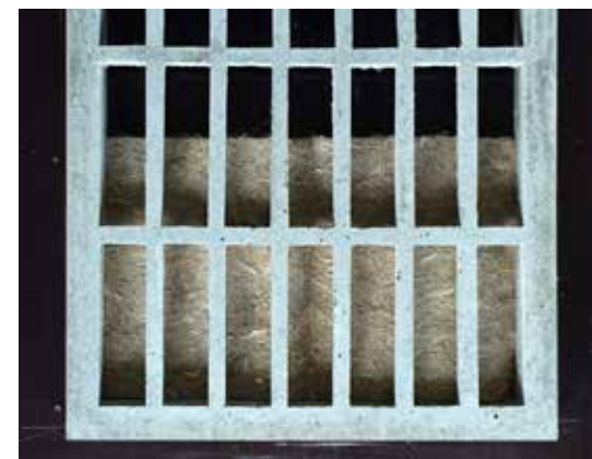
Abb. 54 Betonage eines mehrschichtigen HLB-Plattenmusters, obere Lage HLB mit steifer Konsistenz
