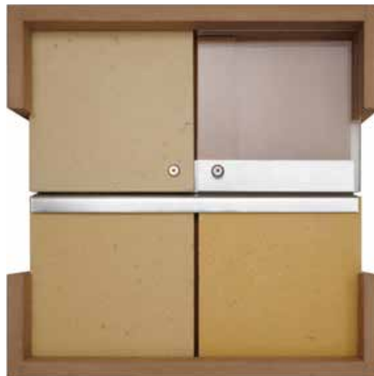
Abb. 31 MK_3, wie MK_2 plus Edelstahlwinkelschiene, gekantet nach Maß
