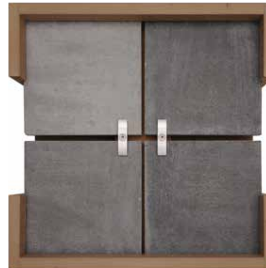
Abb. 32 MK_7, Halterungswinkel (Aluminium)
