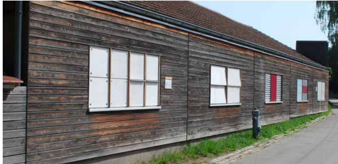
Abb. 34 Fassadenteststand der Fa. Keilholz (Nürnberg-Kraftshof) mit drei HLB-Versuchsflächen, Variante 1 (links), 2 (zweite von links), 3 (rechts)
