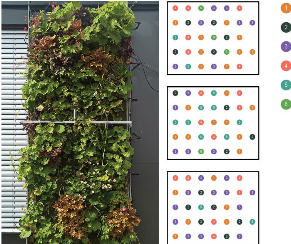
Abb. 49 Fassadenversuchsstand – Variante 1: Vertiko GmbH, Buchenbach mit Pflanzplan (THN-AR) (Pflanzliste vgl. Tab. A10 im Appendix)
