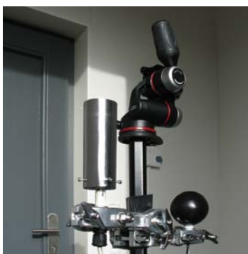
Abb. A14 Innenraumtemperatur Globethermometer (THN-AR)
