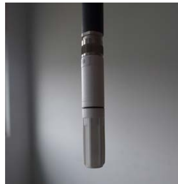
Abb. A47 Kapazitiver Feuchte-sensor (IBP)
