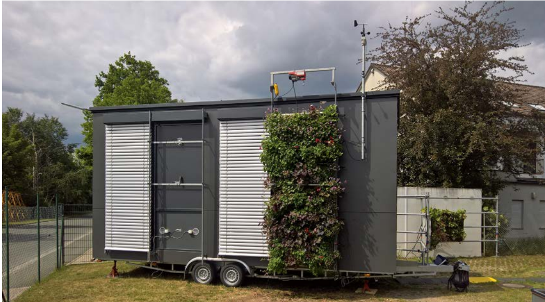
Abb. 41 Rednitzhembach, Technikum/ Fassadenversuchsstand – Referenzbüro mit Dezentraler Fassadenlüftung (DFL) (links) und Aufbau mit Fassadenbegrünung „Variante 2“ (Verticalgreendesign (VGD)) und DFL (rechts, 05/2020) (THN-AR)
