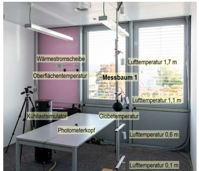
Abb. 87 Messaufbau in den Räumen. (IBP)
