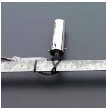
Abb. A11 Oberflächentemperatur, Hygrothermometer (THN-AR)
