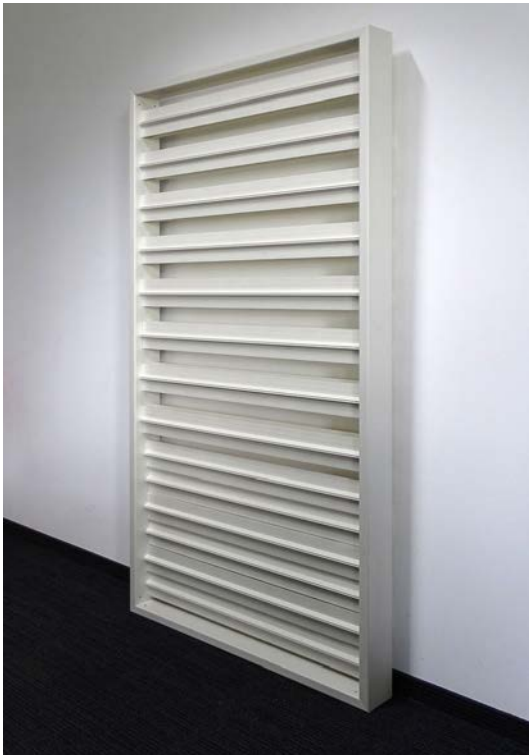
Abb. 75: Fassadenladen mit Brüstungs- und Sichtfeld, Rahmen aus PLA (THN-AR)
