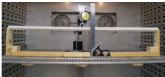
Abb. 93: 90 cm Profil mit abgenommenen Flügeln im Wechselklimaschrank mit angelegter Messuhr und Kombinationswinkel zur Erfassung der auftretenden Verformung in der Profilmitte (THN-BI)
