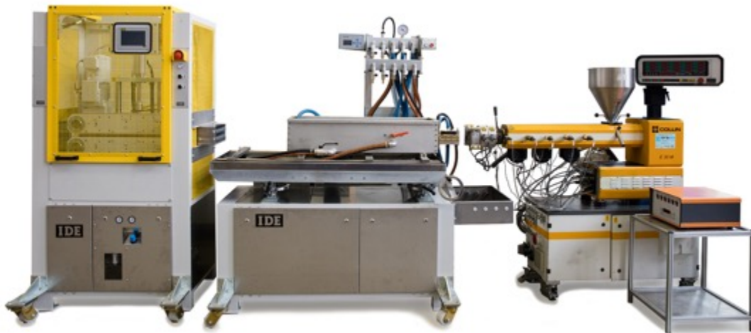
Abb. 167: Extrusionsanlage inkl. Werkzeug, Kalbrierung und Abzug zur Herstellung der plattenförmigen Probekörper
