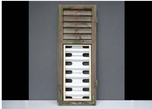
Abb. 84: Klappladen (Fichte): Belegung mit Fassadenladenprofil – abgerundete Einschnitte für Außenbezug (THN-AR)
