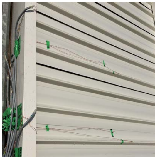
Abb. 146: Temperatursensoren auf Funktionsmodell „Brüstungsbereich“ (Fh-IBP)
