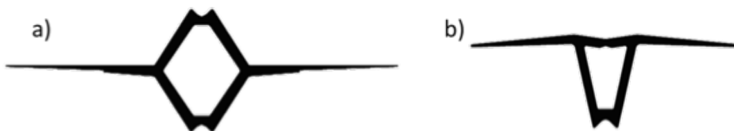
Abb. 26: Ausgewählte Konturen für die beiden Extrusionsprofile R 1.2.3 (a) und D 1.3.1 (b) (THN-AR)
