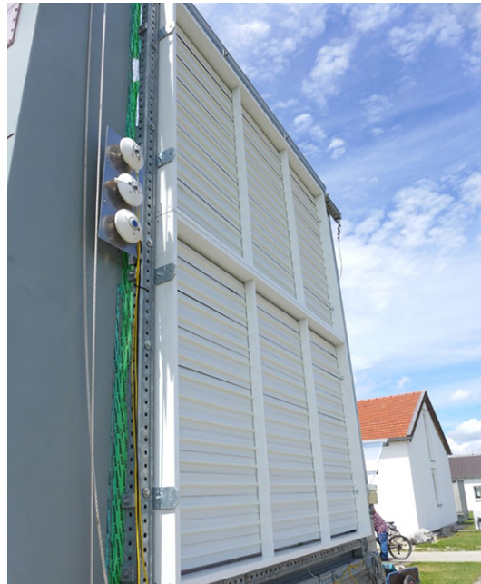
Abb. 141: Messtechnik an Prüfbox außen (Fh-IBP)
