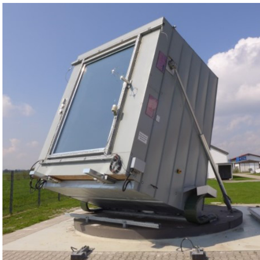
Abb. 138: Kalorimetrischen Dach- und Fassadenprüfstand (Fh-IBP)
