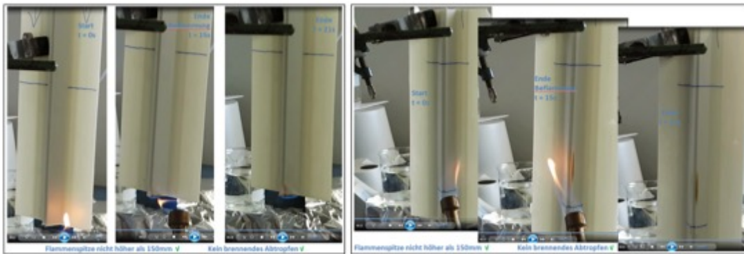
Abb. 36: Brandprüfung am Profil R 1.2.3; links Kanten-, rechts Flächenbeflammung (Joma-Polytec)
