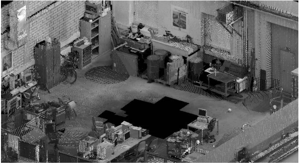
Abbildung 25: Punktwolke der Maschinenhalle, alte Maschine gelöscht [Büttner 2012]
