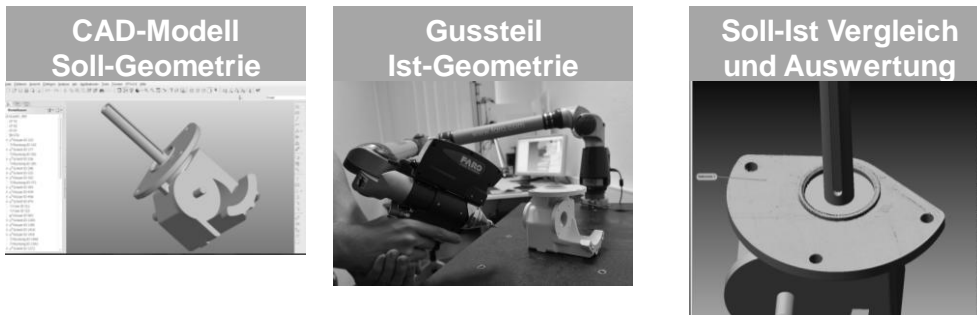
Abbildung 20: Soll-/Ist-Vergleich von Gussteilen
