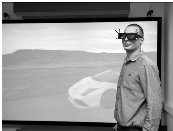
Abbildung 14: Trackingssystem mit passiven Reflektorkugeln zur Erfassung der Kopfposition
