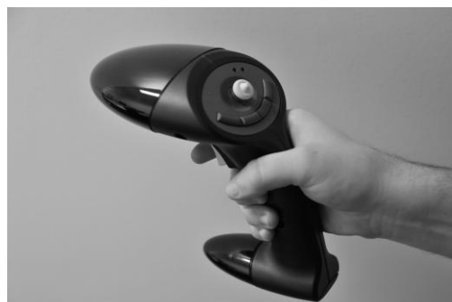
Abbildung 13: im 3D-Visualisierungszentrum eingesetzter Fly-Stick der Fa. Advanced Realtime Tracking GmbH
