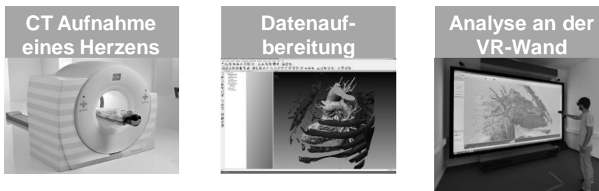
Abbildung 19: Stereoskopische Visualisierung der CT-Daten eines Herzen
