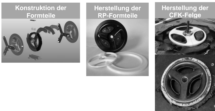
Abbildung 23: Herstellung von Kernformen nach dem Rapid Shaping Prozess
