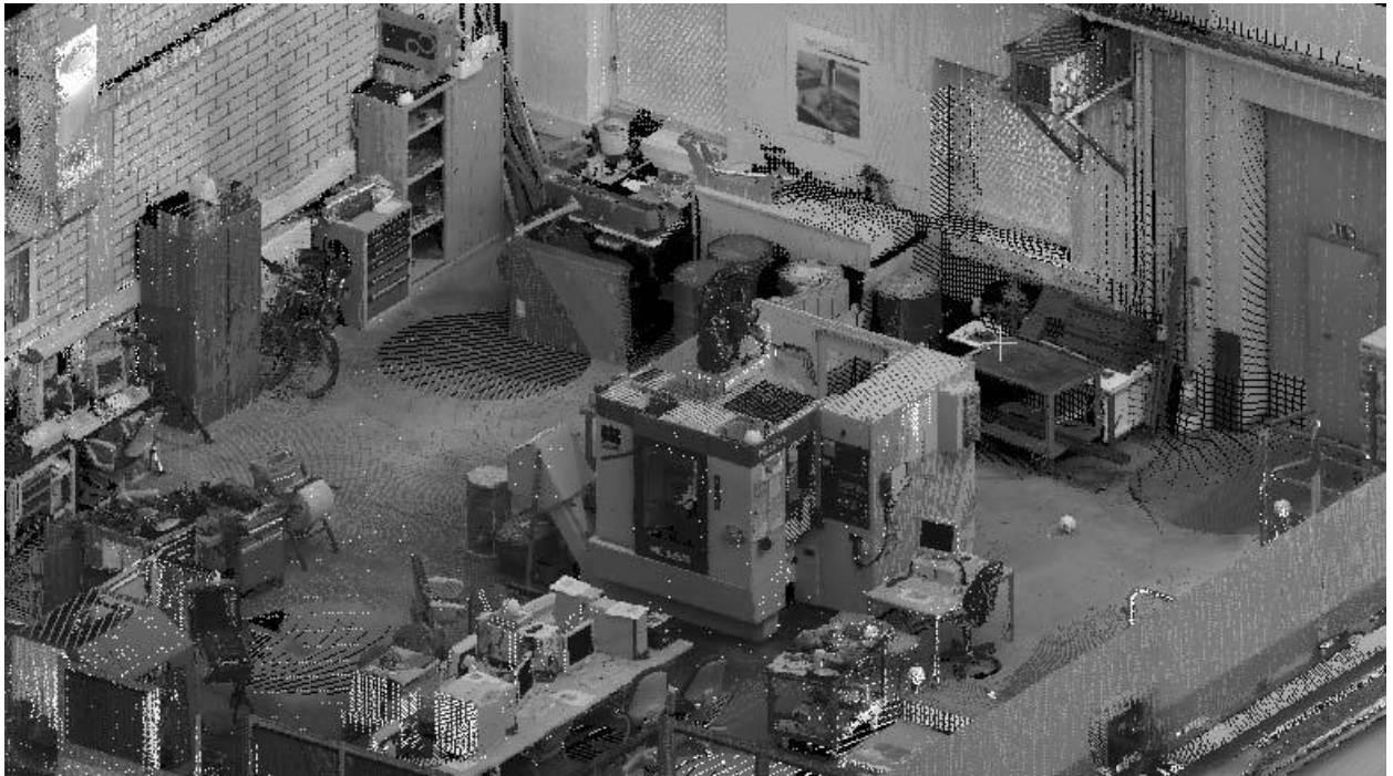
Abbildung 24: Punktwolke der Maschinenhalle mit alter Maschine [BÜTTNER 2012]
