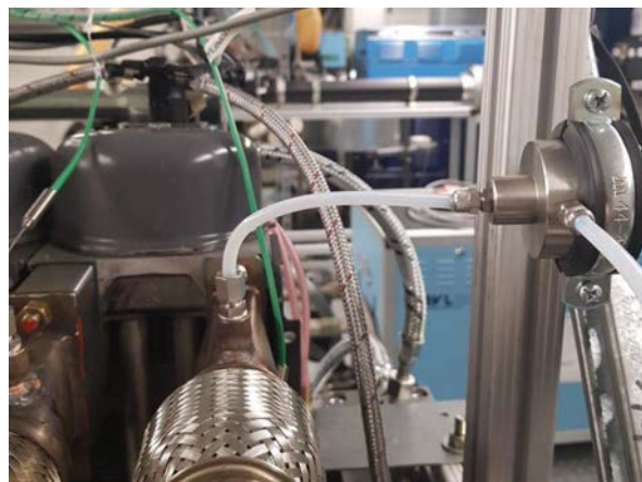
Abbildung 3: Detailansicht der NH 3 -Einspritzung Zylinder 1. Bild: Thomas Untheim
