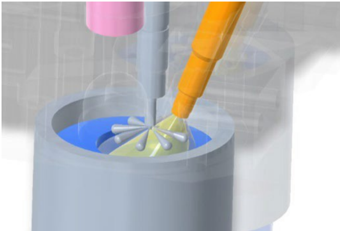
Abbildung 8: Resultierender Bildkegel des Endoskops. Bild: Thomas Untheim
