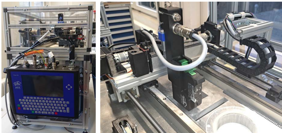
Abbildung 6: Steuerungseinheit und Druckkopfhalterung des verwendeten Inkjet-Systems. Bild: Michael Koch
