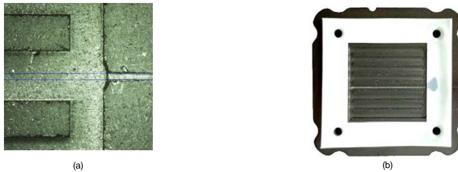
Abbildung 5: Geprägter Kanal in der Bipolarplatte (a) und eingeklebte Faser mit FBG (AOS 1555 nm) in geprägte Bipolarplatte (b). Bilder: Katharina Rostan, Projektbericht RealTempFC.
