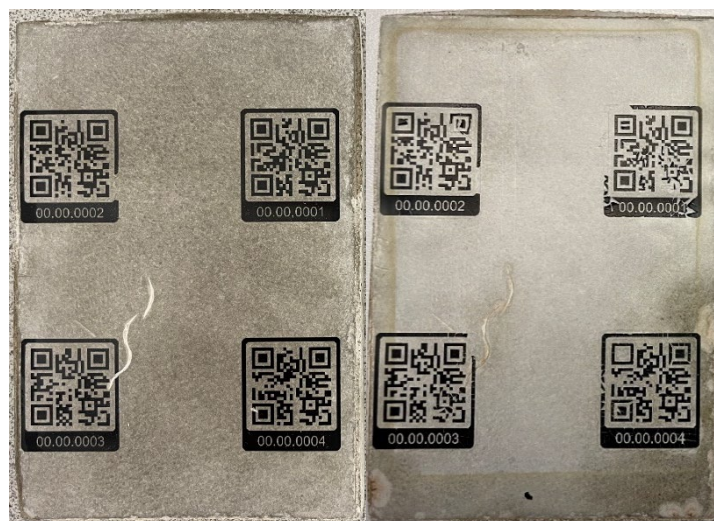
Abbildung 4: Ergebnis nach der beschleunigten Bewitterung in QUV Bewitterungstester nach 0 h (links) und 1800 h (rechts). Bild: Roland Kraus
