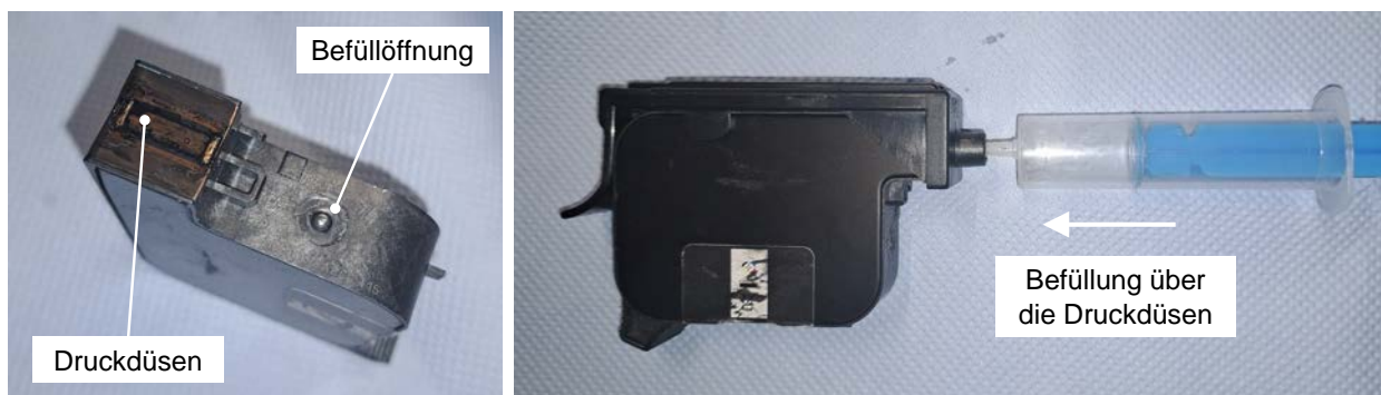
Abbildung 5: Verwendete Druckpatrone HP45 mit Befüllung über die Druckdüsen. Bild: Michael Koch
