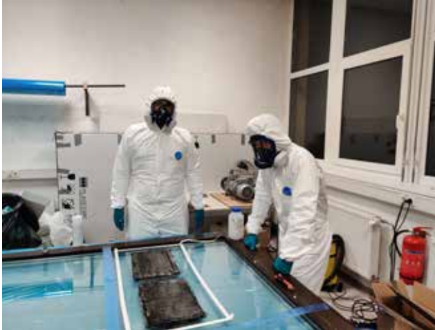
Abbildung 3: Herstellung von Karbontestplatten Foto: Strohm und Söhne e.V.
