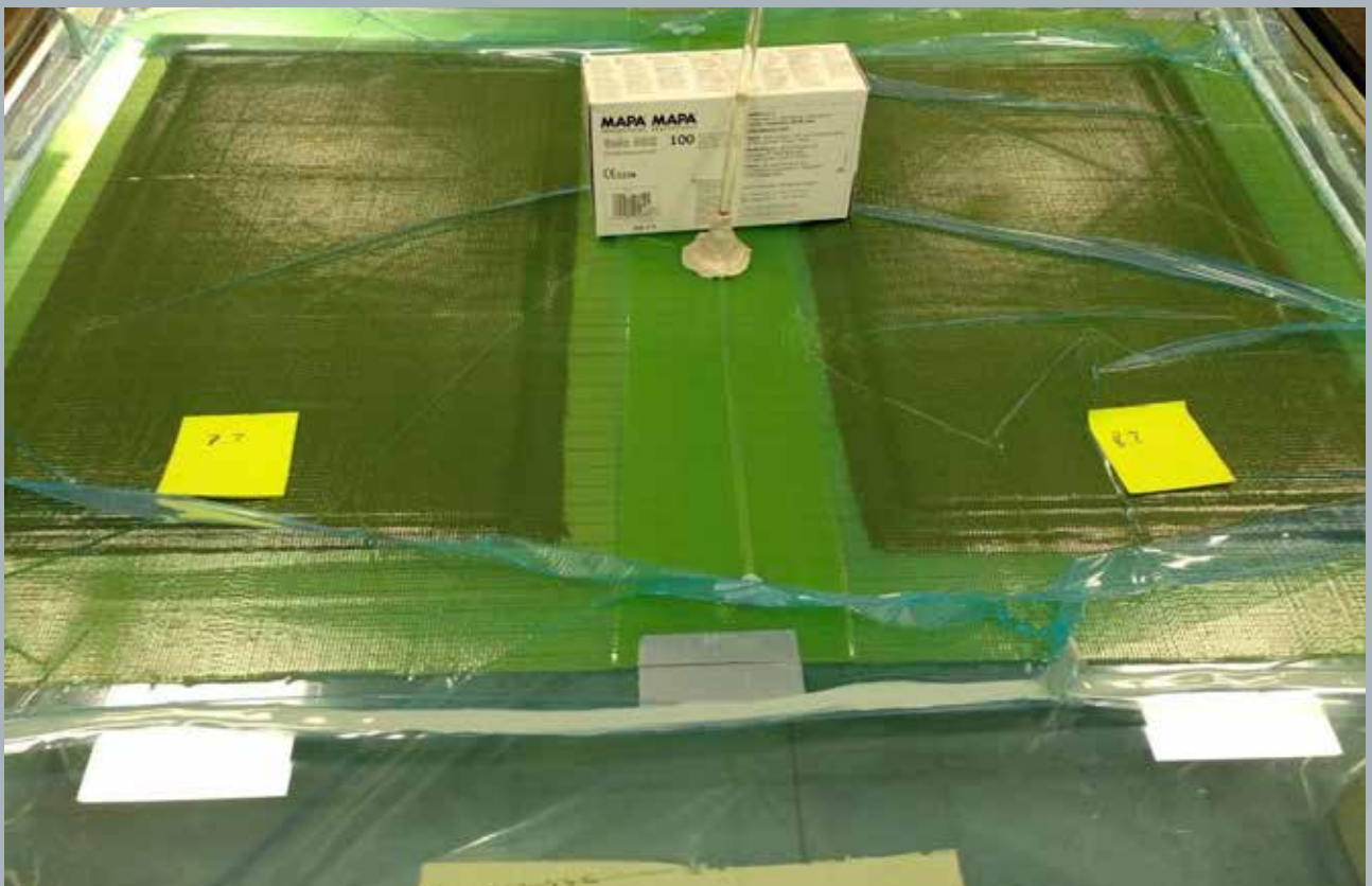
Abbildung 3: Herstellung von Carbondestplatten. Foto: Strohm und Söhne e.V.
