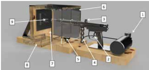
Abbildung 1 Konzept des Versuchsstandes zur Einzelkornzerkleinerung von Materialien mit komplexen Materialverhalten mittels Prall- und Schneidbeanspruchung. Grafik: Moritz Eisenlauer
