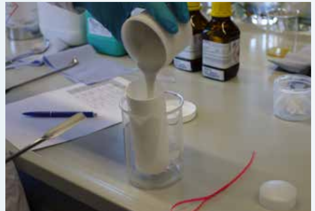
Abbildung 4: Silantermierter Polyetherklebstoff (STP-E) bei der Abfüllung in 150-ml-Kartuschen. Foto: Andreas Conrad
