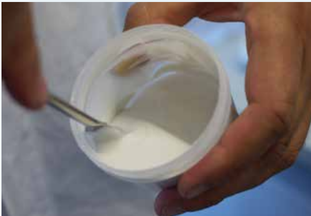
Abbildung 3: Silantermierter Polyetherklebstoff (STP-E) nach der Herstellung im SpeedMixer. Foto: Andreas Conrad
