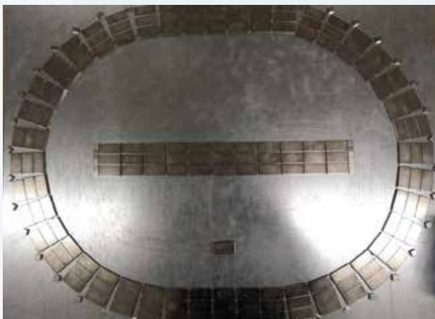
Abbildung 3: Ringförmige Magnetschiene auf Metallplatte. Foto: Mertkan Özcan
