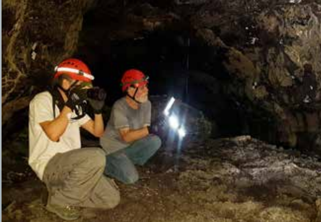
Abbildung 4: Photogrammetrische Erfassung der Wandoberfläche Beleuchtung mit einer 5.500-K-LED-Flächenleuchte. Foto: Thomas Killing
