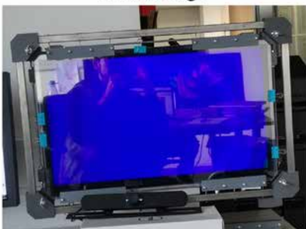
Abbildung 4: Nach Durchführung des Teach-In Algorithmus sind die Bilder für die entsprechenden Augen nahezu frei von Moiré-Effekten. Foto: Andreas Pazureck
