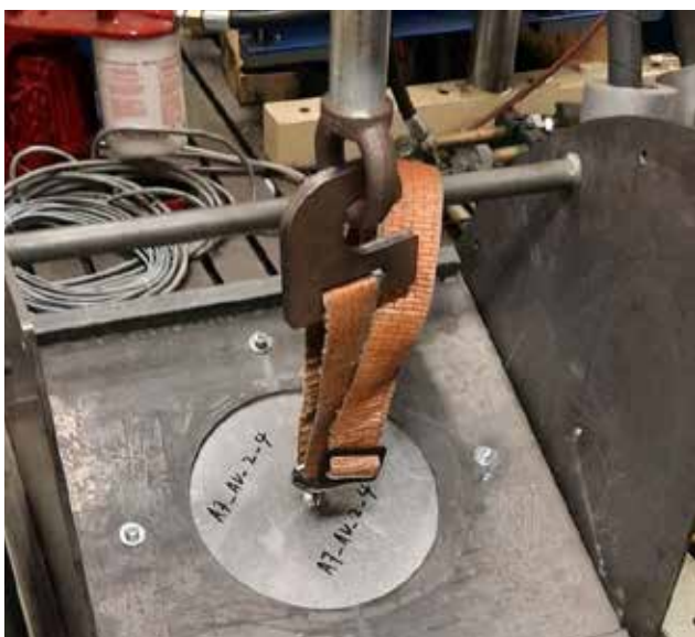
Abbildung 4: Ausreißversuch an der Hochschule. Foto: Strohm und Söhne e.V.)
