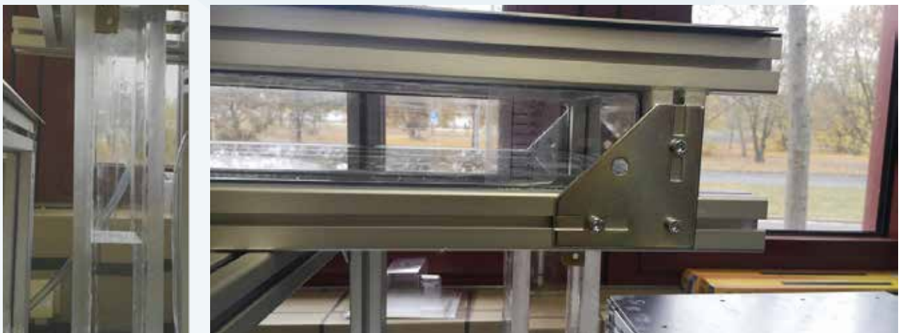
Abbildung 4: Ansicht auf den Stand des Silikonöls im Ansaugrohr (links) und in der Vakuumläuterkammer (rechts) bei eingeschalteter Vakuum- und Förderpumpe. Foto: Kevin Geier
