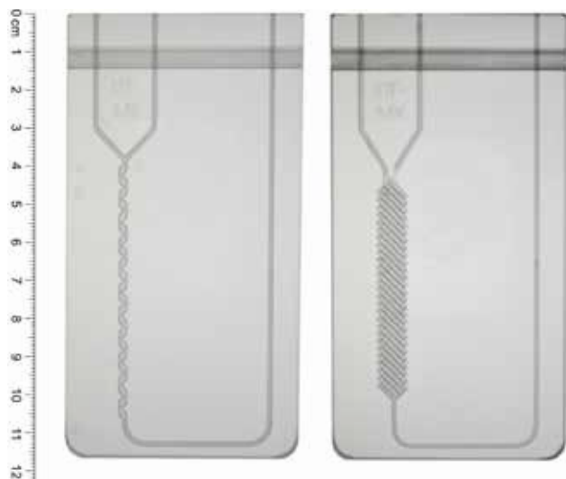
Abbildung 4: Aufbau für Reaktionen mit einer flüssigen und einer gasförmigen Phase. Foto: Yvonne Ilmberger
