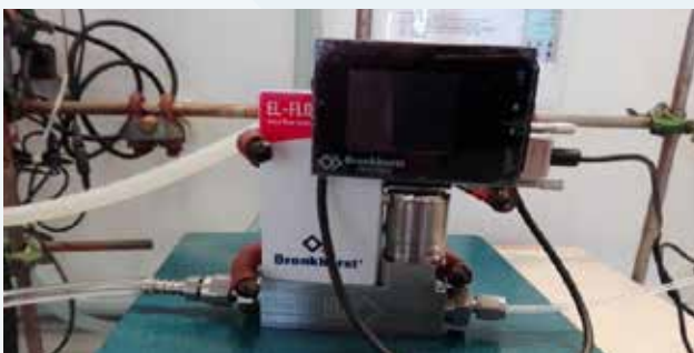
Abbildung 2: Massendurchflussregler EL-FLOW ® Prestige. Foto: Yvonne Ilmberger
