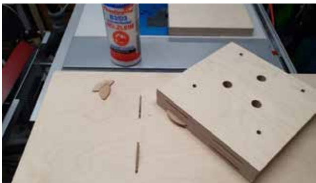
Abbildung 6 : Flachdübelverbindung der Holzbauteile. Foto: Moritz Eisenlauer
