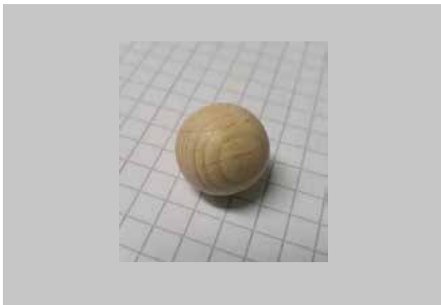
Abbildung 10: Buchenholz-Modellpartikel mit den Durchmessern d = 15 \text{ mm} (links) und d = 4 \text{ mm} . Fotos: Moritz Eisenlauer
