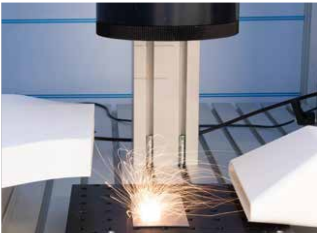
Abbildung 1: Prozessemissionen bei der Laserstrukturierung von Metallblechen. Foto: Andreas Schkutow
