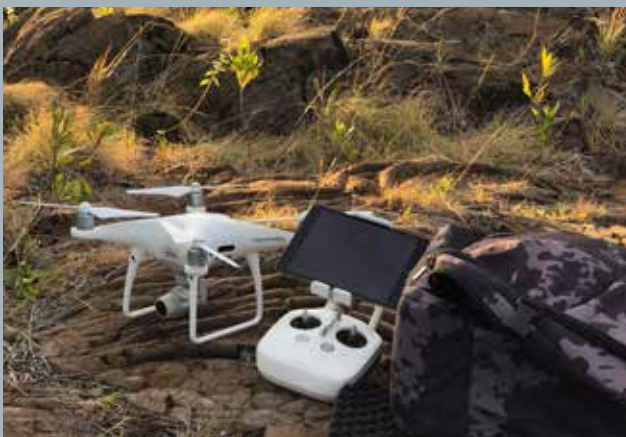
Abbildung 6: Phantom 4 mit einer 20-MP-Kamera und einem 1 Zoll großen Fotosensor. Foto: Thomas Killing
