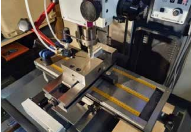
Abbildung 7: Fräsen des Aluminiumblockes. Foto: Moritz Eisenlauer
