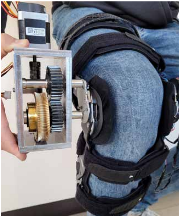
Abbildung 1: Prototypische Realisierung des Antriebes einer aktiven Knieorthese. Symbolhaft dargestellt ist eine denkbare mech. Kopplung an die eigentliche Orthese bei einem zweiachsigen Antrieb. Foto: Pirmin Hilbrand, Julius-Paul Poppendörfer, Elias Sinz
