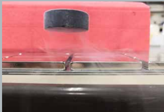
Abbildung 4 und 5: selbst hergestellter polykristalliner Supraleiter (links); gekaufter, gerichteter Supraleiter (rechts). Fotos: Mertkan Özcan
