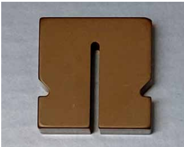
Abbildung 5: CNT/Al 2 O 3 -Keramik in Form eines „Ohms“. Foto: Achim Rübling
