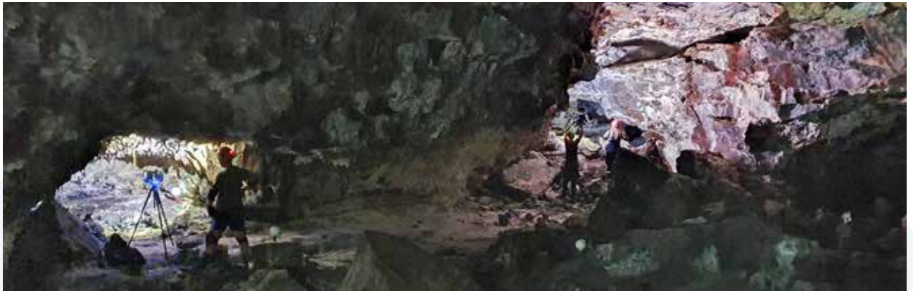
Abbildung 1: Dreidimensionale Erfassung einer Lavahöhle mittels Terrestrischem Laser Scanning TLS (links) und Structure from Motion SfM (rechts). Foto: Michael Kögel
