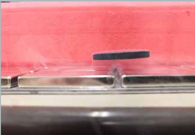
Abbildung 4 und 5: selbst hergestellter polykristalliner Supraleiter (links); gekaufter, gerichteter Supraleiter (rechts). Fotos: Mertkan Özcan
