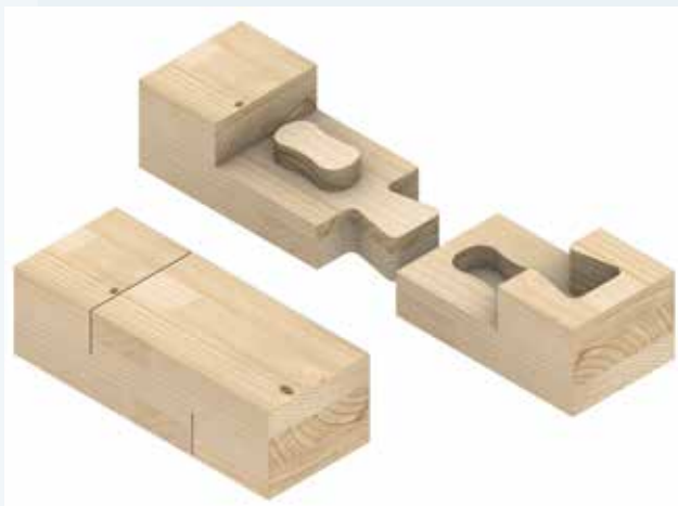
Abbildung 8a: Rendering der gefrästen Holzverbindung, Grafik: Valentin Viezens
