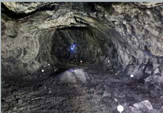
Abbildung 2: Anordnung der Referenzkugeln und des 3D-Laserscanners während eines Aufnahmeprozesses. Foto: Michael Kögel
