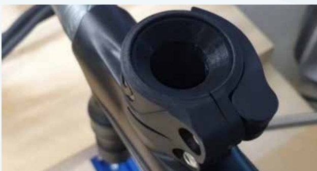
Abbildung 4: Reduzierung der Ladeöffnung des Markierers zum Schutz gegen manuellen Zugriff. Foto: Moritz Eisenlauer
