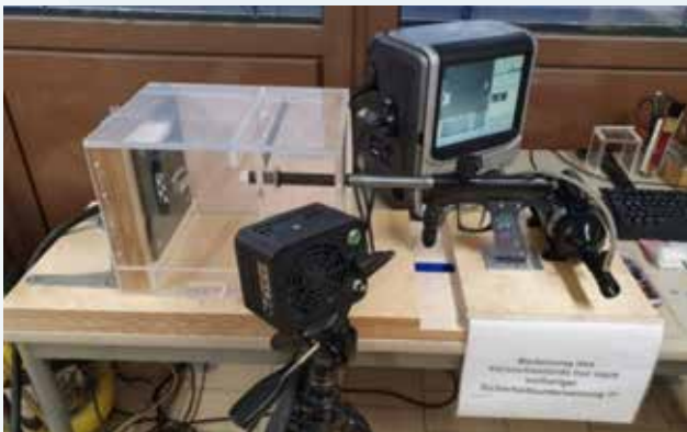
Abbildung 8: Versuchsstand zur Einzelkornzerkleinerung mit High-Speed-Kamera und Beleuchtung. Foto: Moritz Eisenlauer
