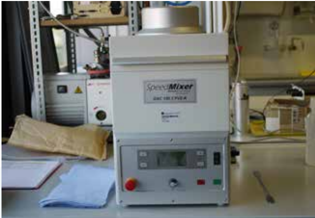
Abbildung 1: Der SpeedMixer von der Fa. Hausschild wurde zur Herstellung der Kleb- und Dichtstoffe verwendet. Die Anschaffung war durch die Förderung der Lehrforschung erst möglich. Foto: Andreas Conrad
