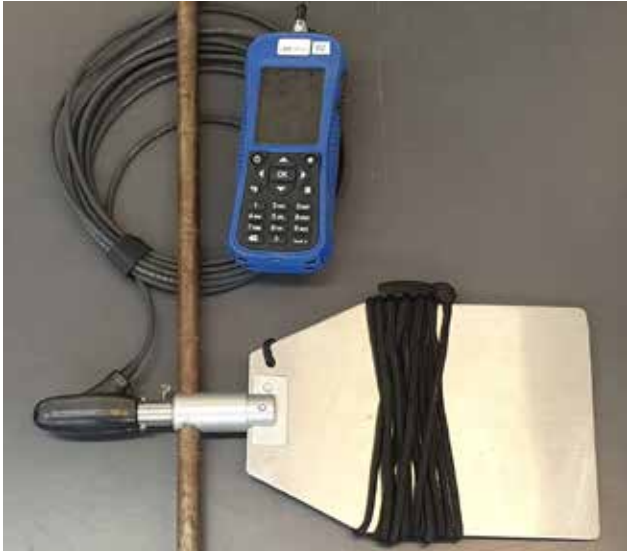
Abbildung 3: Magnetisch induktives Abflussmesssystem der Fa. OTT, Modell MFpro. Foto: Tilo Vollweiler
