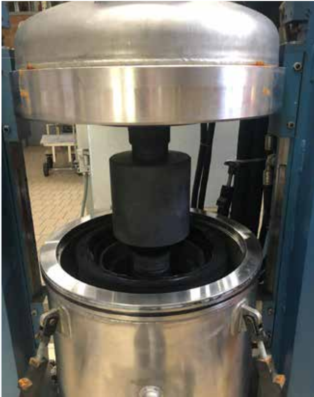
Abbildung 2: Blick in die Heißpresse mit Presswerkzeug. Foto: Hannes Kühl
