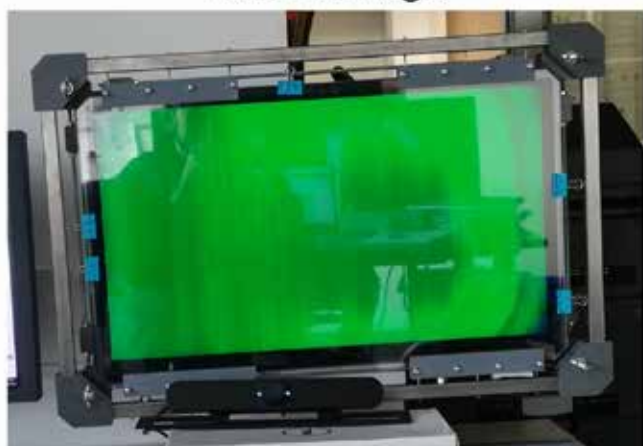
Abbildung 4: Nach Durchführung des Teach-In Algorithmus sind die Bilder für die entsprechenden Augen nahezu frei von Moiré-Effekten. Foto: Andreas Pazureck
