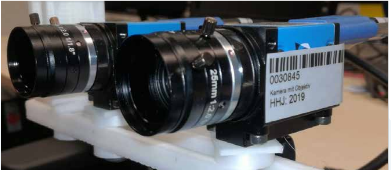
Abbildung 2: Durch den Einsatz zweier Kameras, die als Stereoskopiekamera agieren, ist es möglich die Ungenauigkeiten der aufgedruckten Parallaxenbarriere auch bei grösseren Abständen auszugleichen. Foto: Andreas Pazureck
