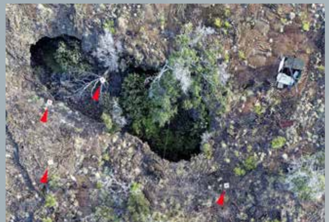
Abbildung 7: Luftaufnahme des Eingangsbereiches mit ausgelegten Ground Control Points. Foto: Thomas Killing
