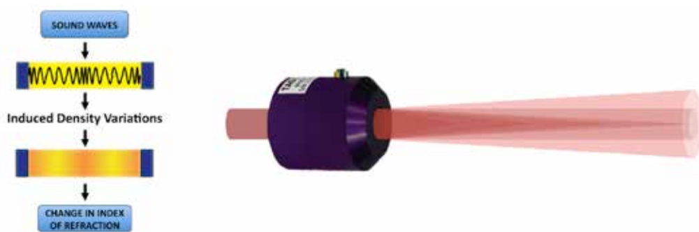
Abbildung 1: Funktionsprinzip der „tunable acoustic gradient index lens“; Grafik: TAGOPTICS [10].
