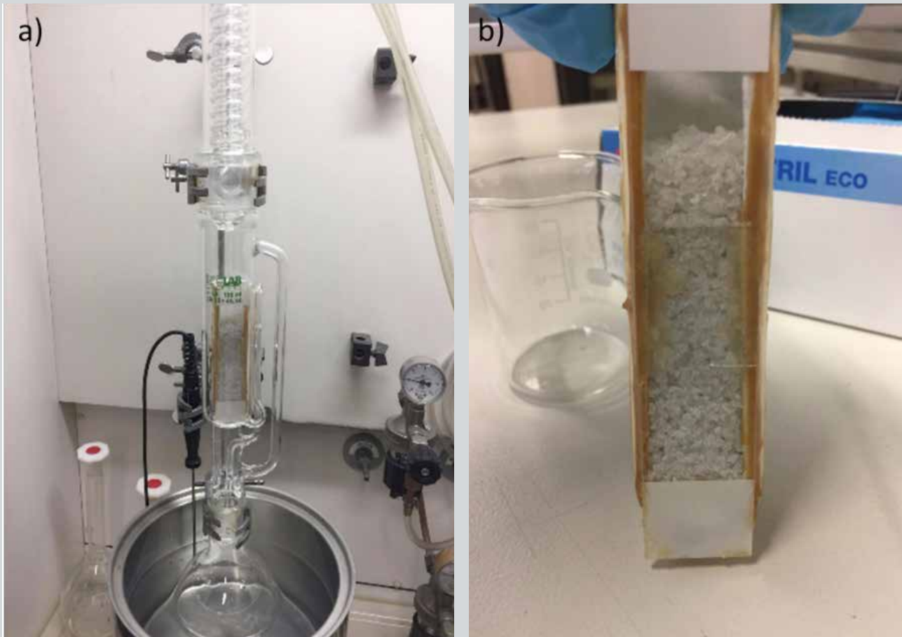
Abbildung 1: Soxhlet-Apparatur über einem Temperierbad (a) sowie die in der Apparatur platzierte Soxhlet-Hülse (Zur Veranschaulichung wurde die Hülse aufgeschnitten) befüllt mit Polystyrol (b); Foto: Thomas Fehn
