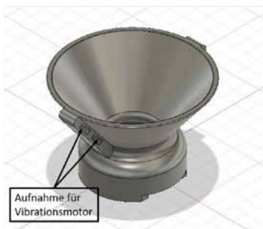
Abbildung 2: CAD-Konstruktion Vibrationstrichter für Einschneckenextruder mit Aufnahmen für Vibrationsmotoren. Grafik: Felix Berthold
