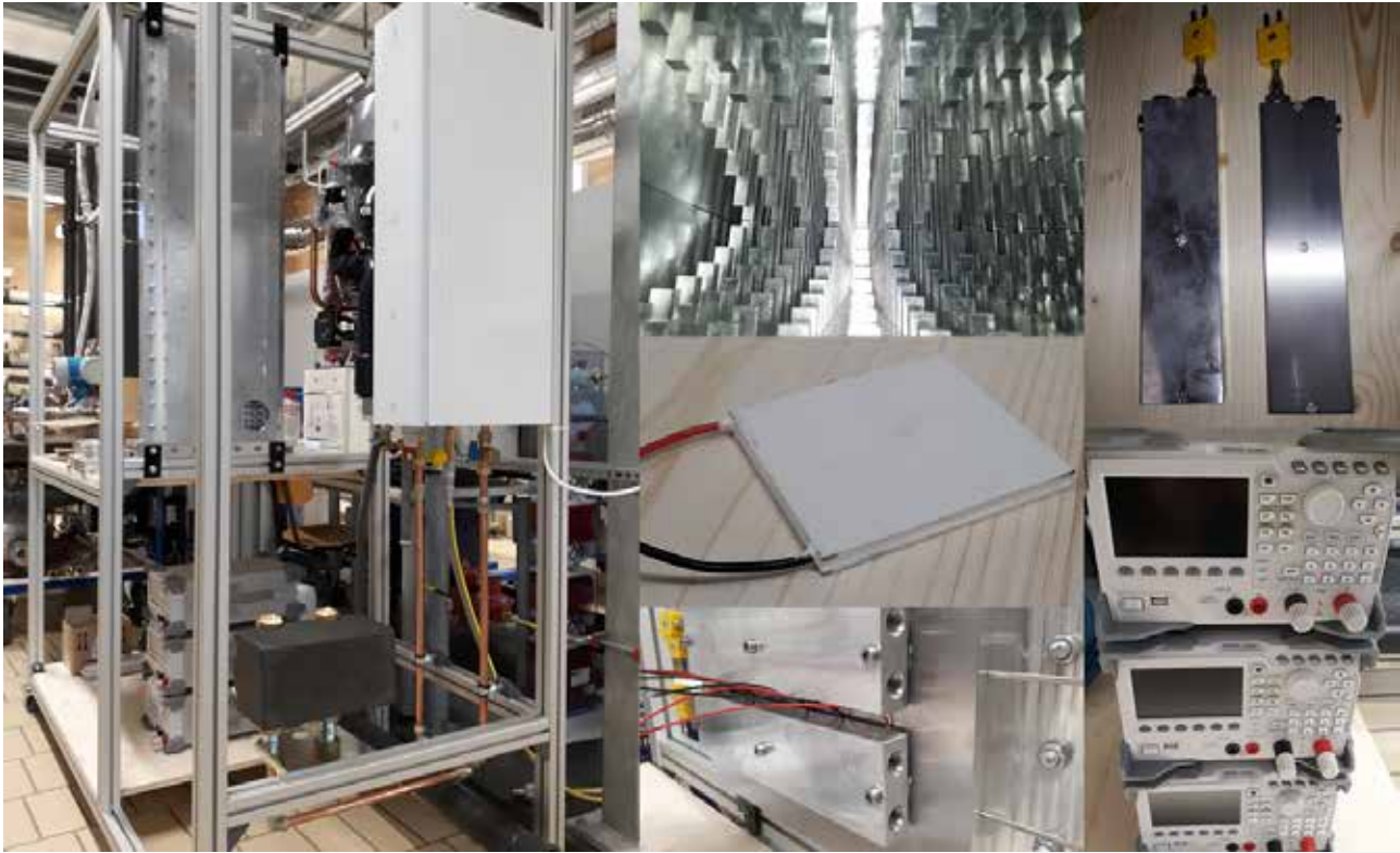
Abbildung 6: Bild der Versuchsanlage während der Montage (links), Detailansicht der Rippen im Wärmeübertrager (Mitte oben), Kühler mit eingebautem Thermoelement (rechts oben); TEG (Mitte); Kühler im eingebauten Zustand mit TEG (Mitte unten); elektronische Lasten (rechts unten); Fotos: Arne Stumpf
