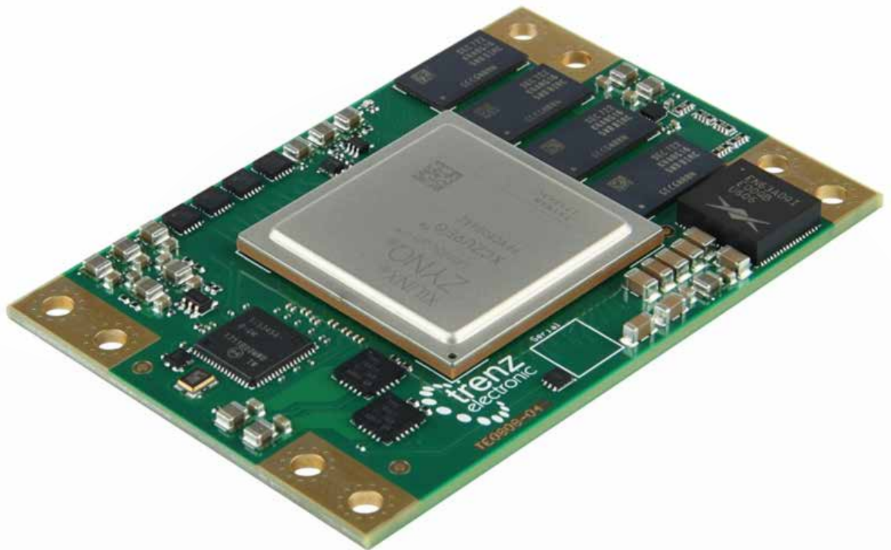
Abbildung 2: Aufsteckmodul der Firma Trenz Electronic mit dem leistungsstarken Xilinx Zynq UltraScale+ MPSoC (Quelle: http://trenz-electronic.de )
