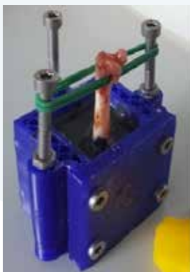
Abbildung 1: Präparierter Taubenknochen für Zugversuche und Ergebnis der Zugversuche; Foto und Grafik: Rüdiger Hornfeck
