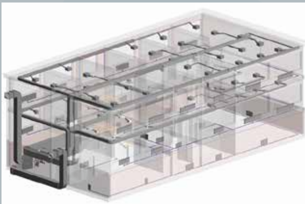
Abbildung 3: TGA-Planung im BIM Gebäudemodell (Abbildung links) und Kollisionsprüfung mit Navisworks (Abbildung rechts)
