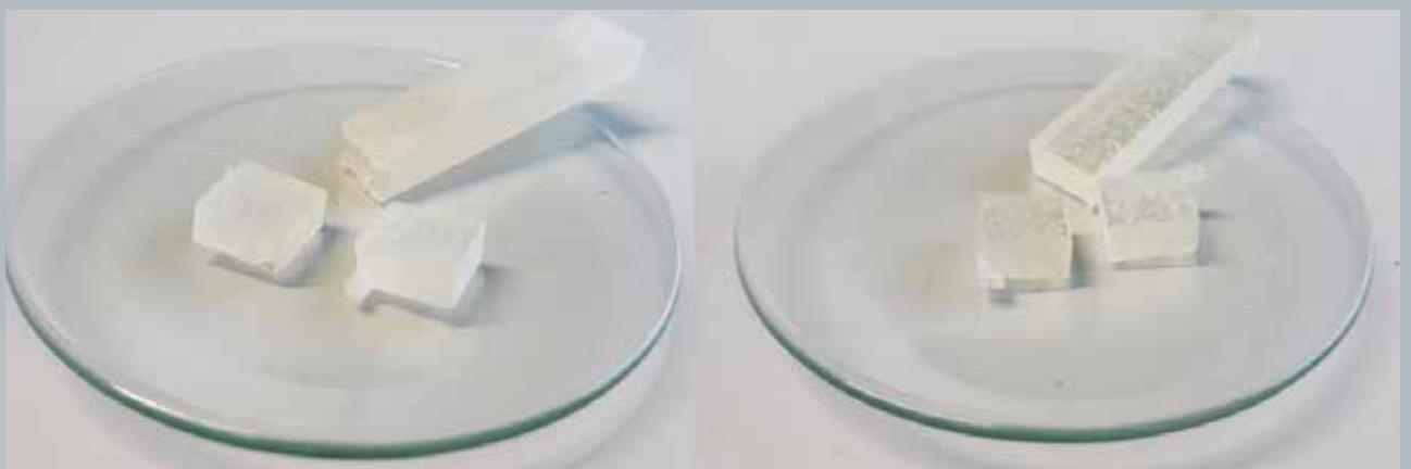
Abbildung 8: Probekörper der Epoxidharze mit Maßen von ca. 10 \times 10 \times 6 mm gehärtet mit Isophorondiamin (links) und 2-Methyl-1,5-diaminopentan (rechts).
