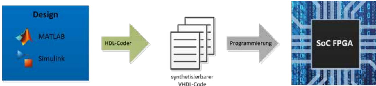
Abb. 3: Workflow zur automatischen Generierung von HDL-Code aus MATLAB/Simulink
