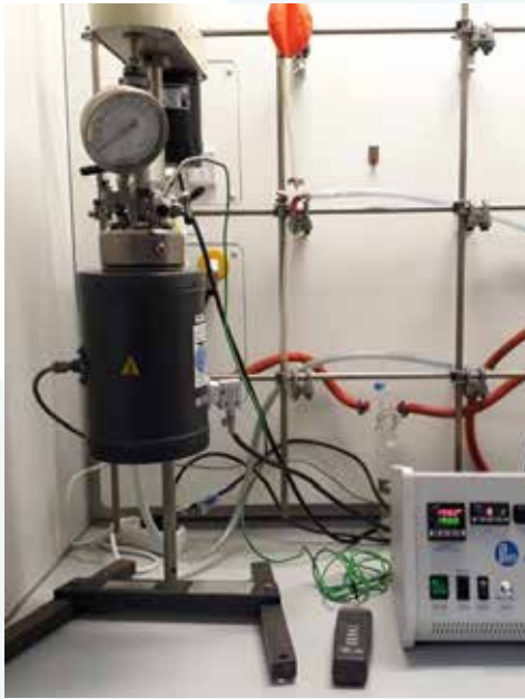
Abbildung 9: Versuchsaufbau mit Autoklav und Kontrolleinheit zur Nachstellung der Versuche von Wang et al.
