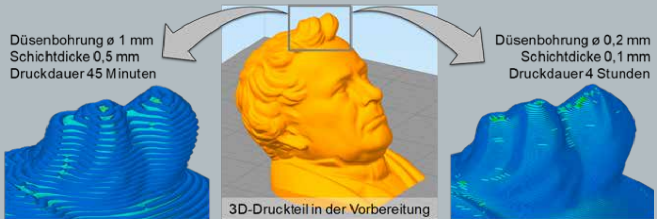
Bild 2: Unterschiedliche Details und Fertigungszeiten durch kleine und große Düsendurchmesser
