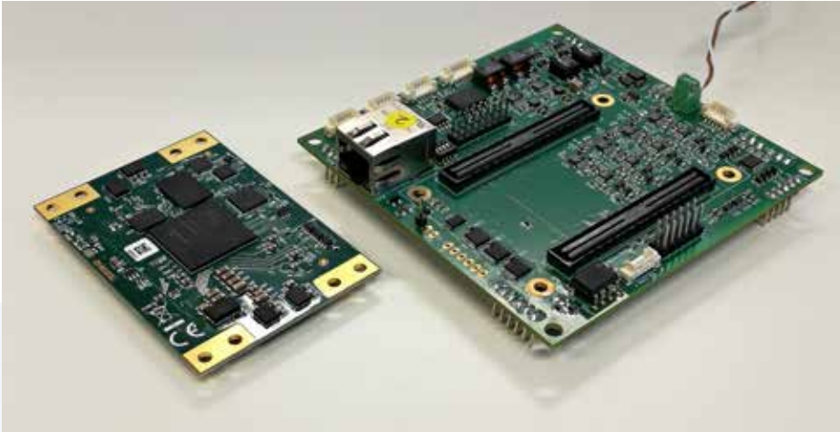
Abb. 5: Eigenentwicklung eines SoC-Systems für die Regelung von elektrischen Antrieben im Rahmen der Vorlaufforschung
