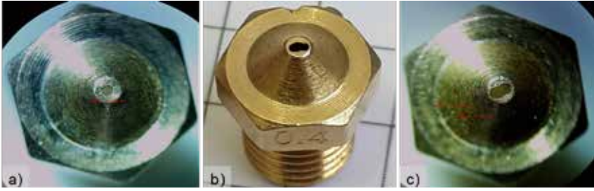
Bild 4: a) Ursprüngliche Düsengeometrie mit Bohrung 0,4 mm; b) und c) modifizierte Nozzle mit langlochförmiger Öffnung
