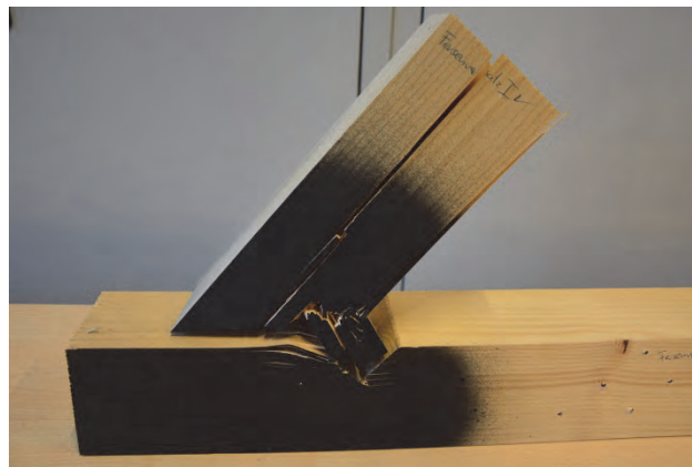
Abb. 3: Versagensform eines Fersenversatzes
