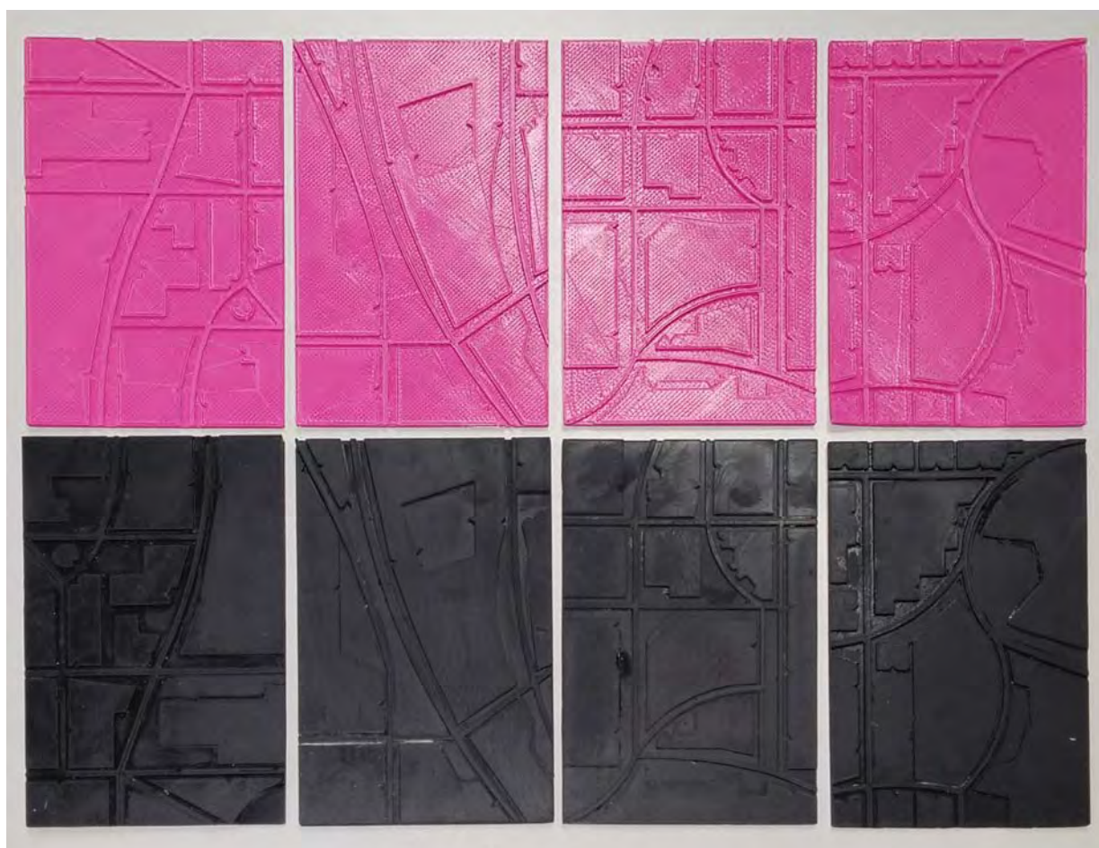
Abbildung 3: Karten zu Testfall 1 (oben: Schmelzschichtungsverfahren, unten: Stereolithographieverfahren). Die beiden Karten auf der linken Seite dienen dabei als zur Erklärung der jeweiligen Aufgaben für die an der Studie Teilnehmenden.
