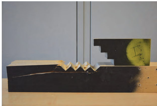
Abb. 4: Versagensform eines Treppenversatzes
