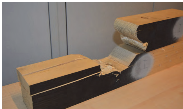
Abb. 5: Unterschiedliches Bruchverhalten bei Wellenversätzen
