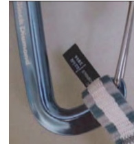
Abbildung 6: Kräfteinleitung über Textilie
