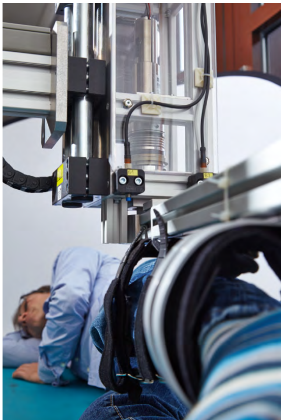
Abbildung 2: Vorrichtung zur Muskeltonusmessung.
