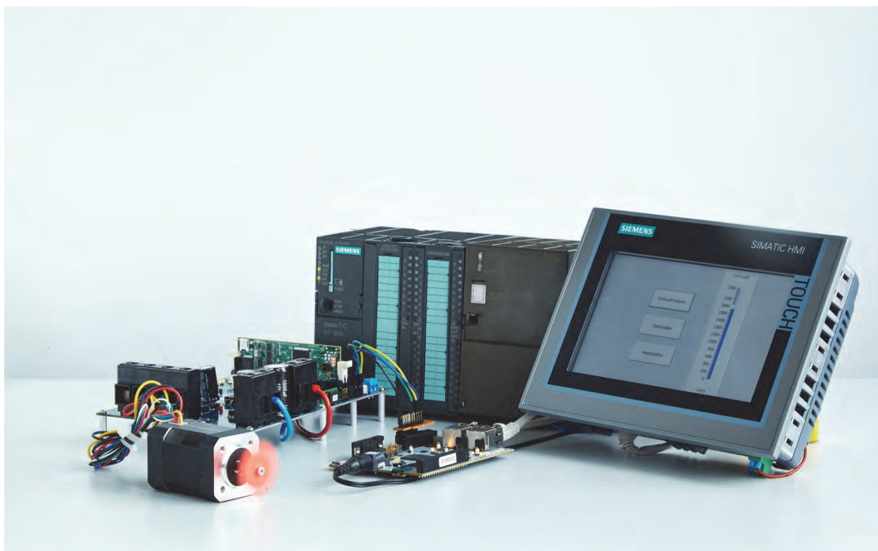
Abbildung 4: Prototyp einer Hardwareplattform für die Entwicklung von MPC-Algorithmen
