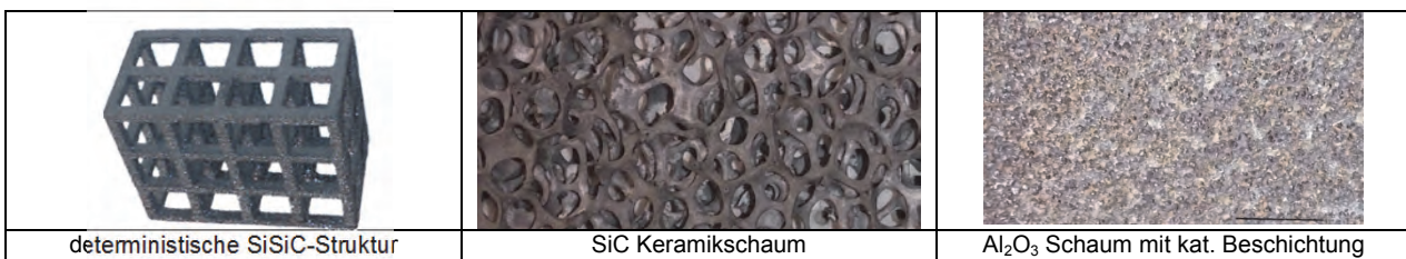
Abb.2: Verbrennungsreaktoren und Strukturen einzeln getesteten Systeme
