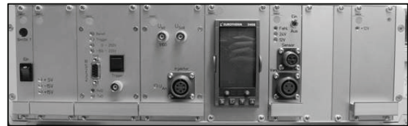
Abb.7. Elektronische Injektorsteuerung von Genotec (CR-Piezoinjektoren)
