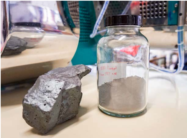
Die künstliche Schlacke (links) ist so fest wie ein Erz. Nach der Erstzerkleinerung werden die Partikel (rechts) in die Rührwerkskugelmühle gegeben und auf Mikrometergröße weiter zerkleinert.
