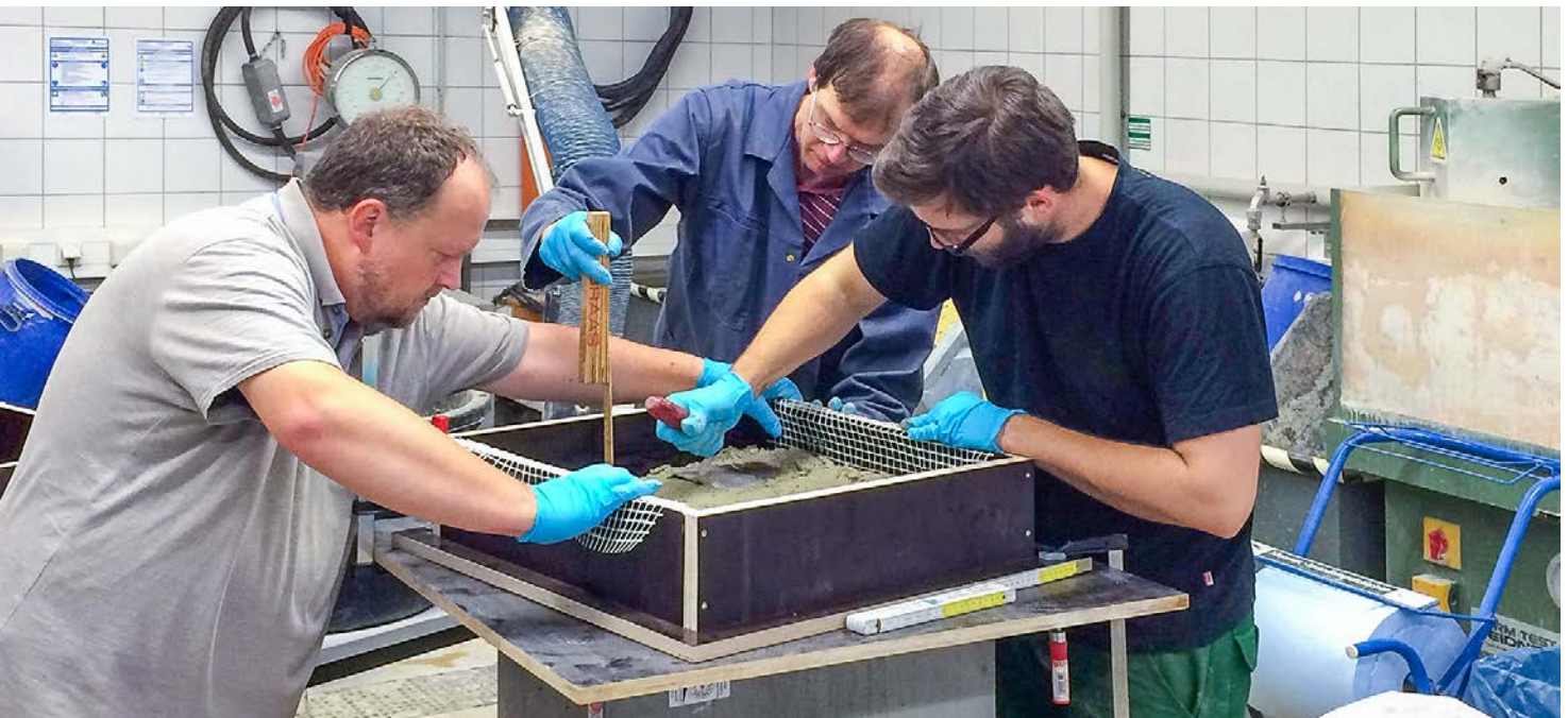
Das Projektteam stellt die Fassadenelemente aus Holzleichtbeton in Handarbeit her.
