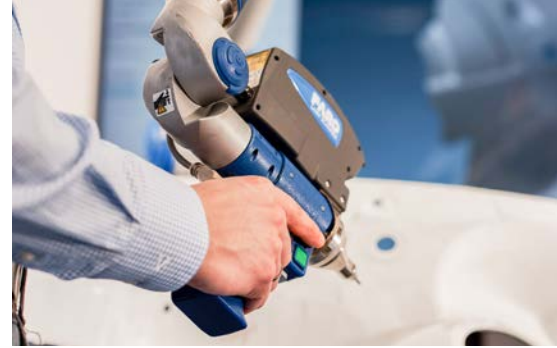
Mit einem handgeführten Scanner lässt sich ein 3D-Oberflächenscan eines Bauteils erstellen.
