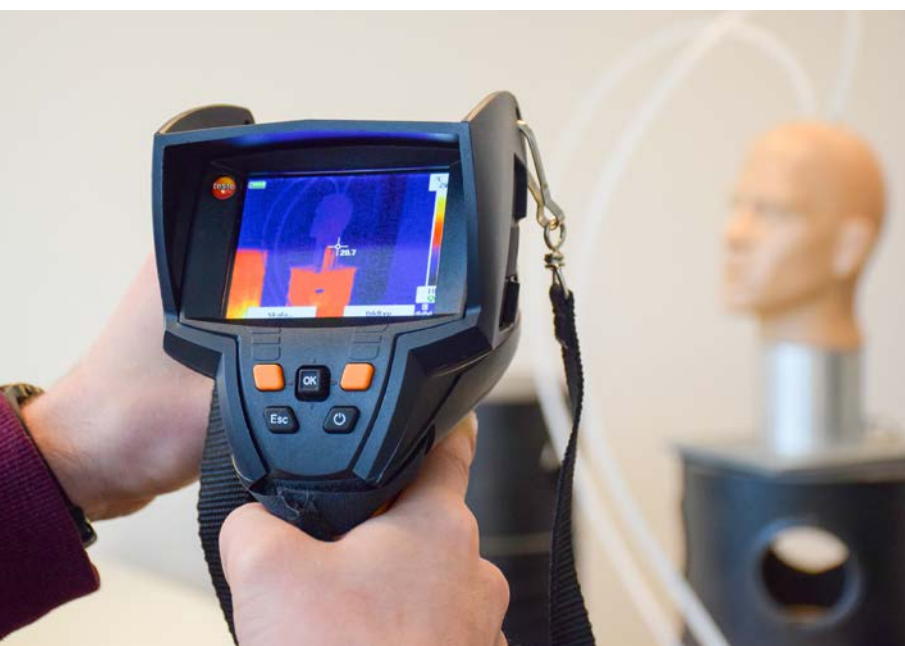
Die Wärmebildkamera zeigt Atem-Dummy und warme Kühllastsimulatoren.
