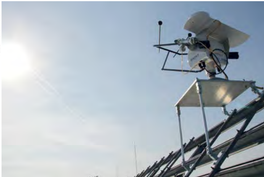
Auf dem Dach der TH Nürnberg: System zur Messung der Sonnenstrahlung bestehend aus Pyranometer und Pyrheliometer, das immer nach der Sonne ausgerichtet ist.
