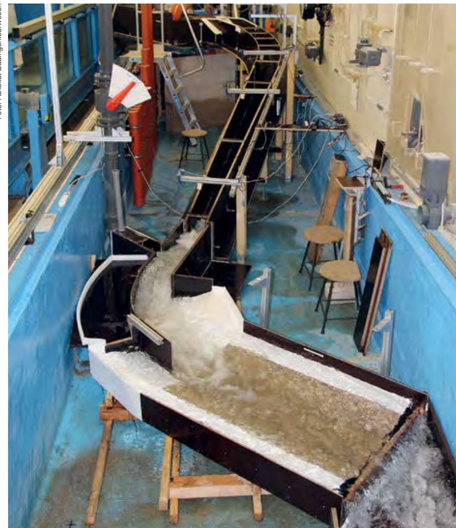
Angewandte Forschung: Versuchsaufbau für das Hochwasserrückhaltebecken in Reinhardtsgrimma.
