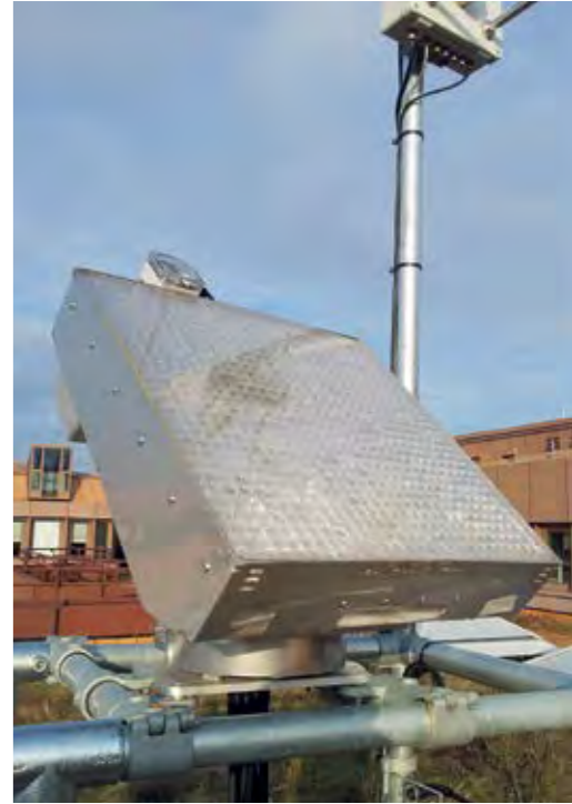
Objekt der Forschung: Der Sollektor mit rund 800 Konzentratoroptiken und Tracking-Sensor.
