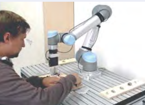
Forschungsprojekt: Kollaborative Montage mit einem Leichtbauroboter.
