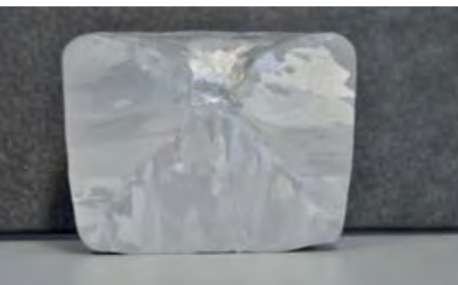
Ein Arbeitsergebnis aus dem Praktikum: Makro-geätztes Gefügebild von Aluminium.
