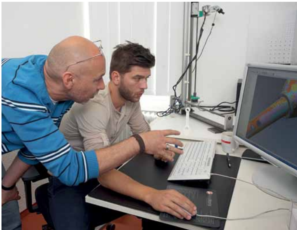
Erfahrungen beim 3D-Scannen: Hat der Laser-Scanner das Objekt abgetastet, entsteht eine Punktwolke am Bildschirm – die Basis für das 3D-CAD-Modell und die exakte Nachbildung des Originals.
