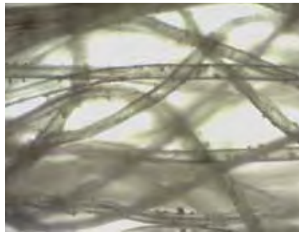
Mikroskopaufnahme der mit Schmutzpartikeln beladenen Fasern in 50-facher Vergrößerung
