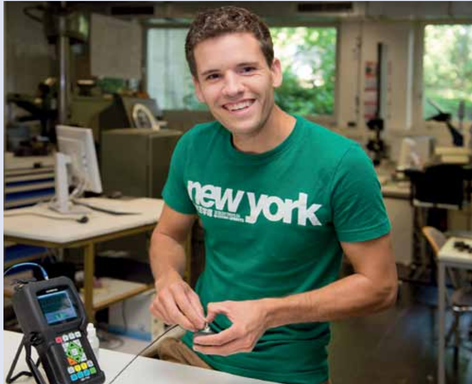
Kooperatives Projekt: Der Student Marco Jenne misst die in einer Schraubverbindung wirkende Schraubenvorspannkraft mit kohlefaserverstärktem Kunststoff als Klemmteil.
