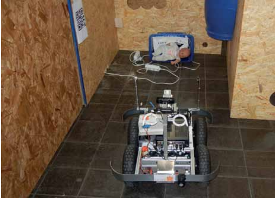
Beim RoboCup Rescue müssen die Roboter Puppen lokalisieren, das Gelände kartographieren und QR-Codes scannen.
