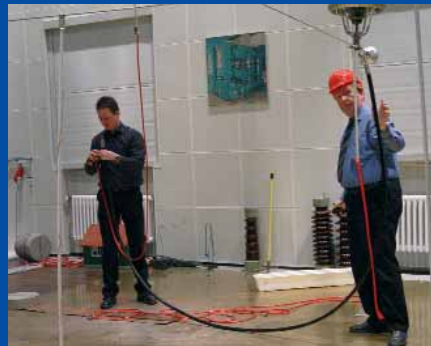
Versuchsaufbau: 1,2 Mio. Volt durch den wassergefüllten Blumenkasten – dank der HVI®-Ableitung der Firma Dehn + Söhne kein Problem.
