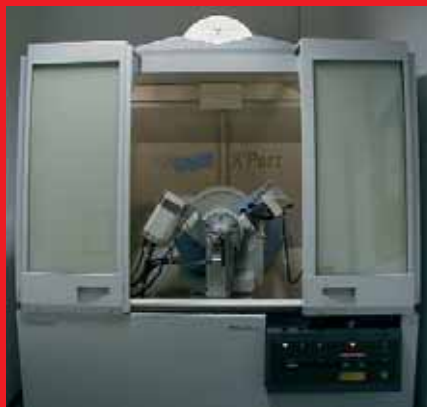
Hochgeschwindigkeits-Röntgendiffraktometer (Firma PANalytical) mit neuester Detektorgeneration und Probenwechsler mit variabler Probenbühne Zusätzliche »Analytik«: Messung von ultradünnen Schichten von 3nm bis ca. 500nm
